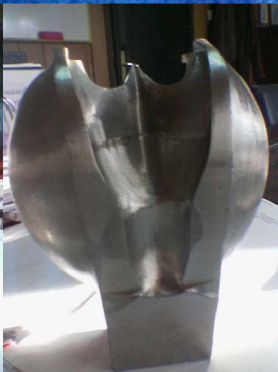
Pelton lopatica nakon obrade i montaže na rotor
