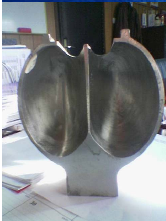
Pelton lopatica nakon obrade i montaže na rotor
