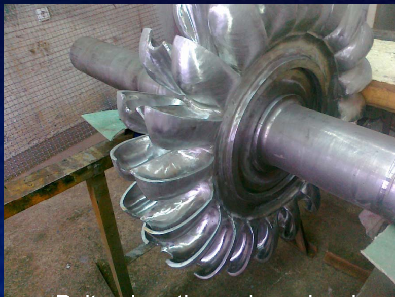
Pelton lopatica nakon obrade i montaže na rotor
