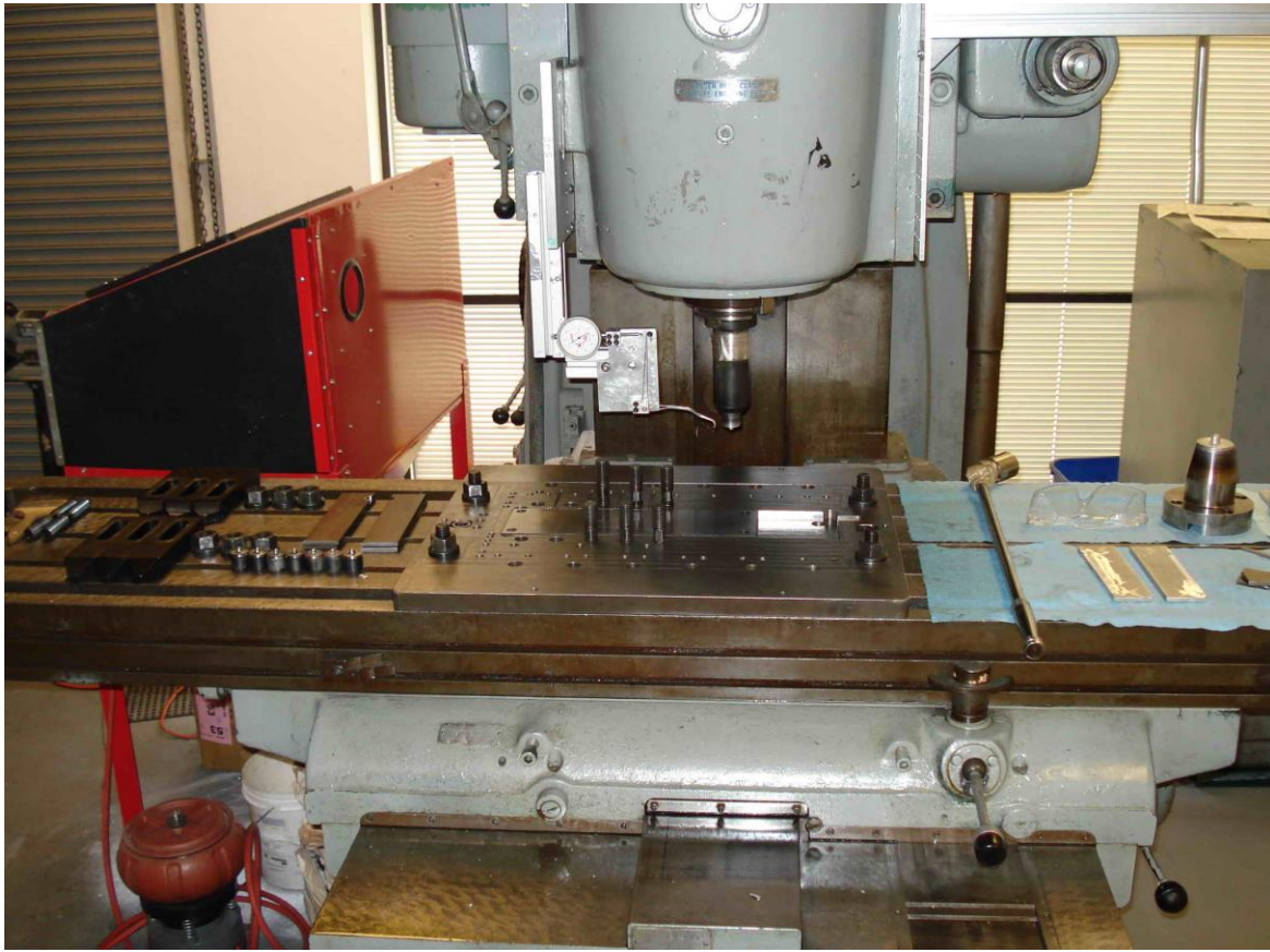
Sl.4. Pripremljena glodalica marke "Cincinati", nominalne snage 50 kW za FSW sa potrebnom priborom i materijalom
