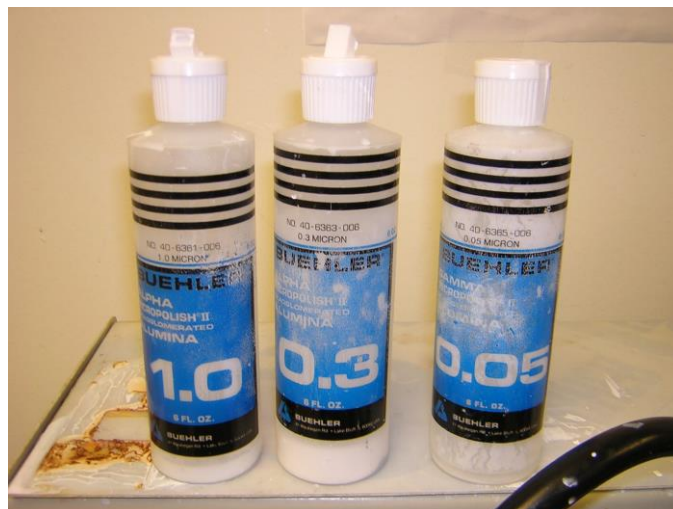
Sl.27. Abrazivi različite granulacije za fino poliranje
