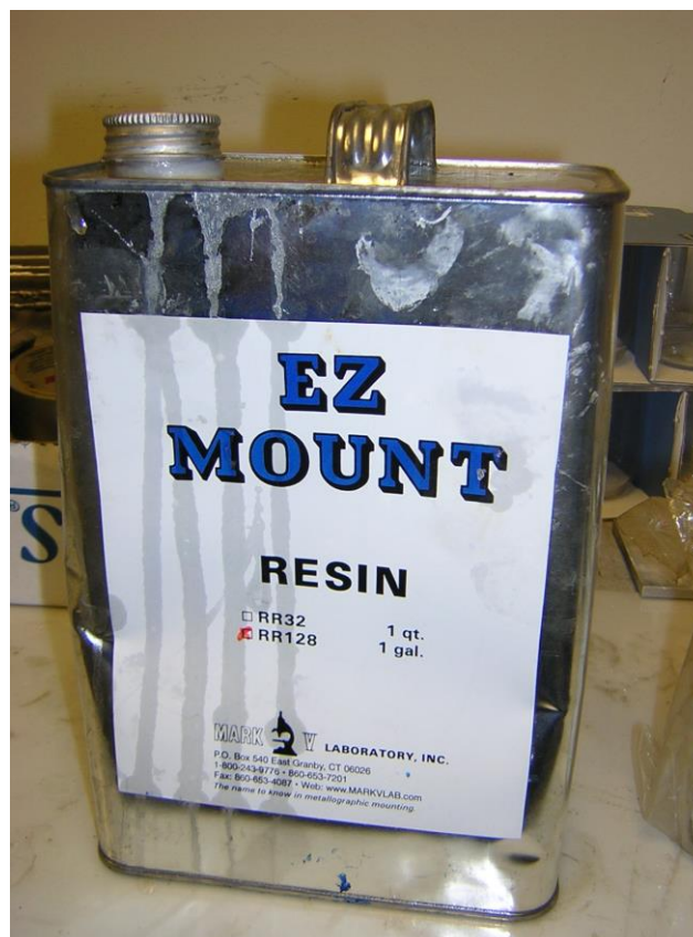
SI.20. Resin - smola za zalivanje uzoraka
