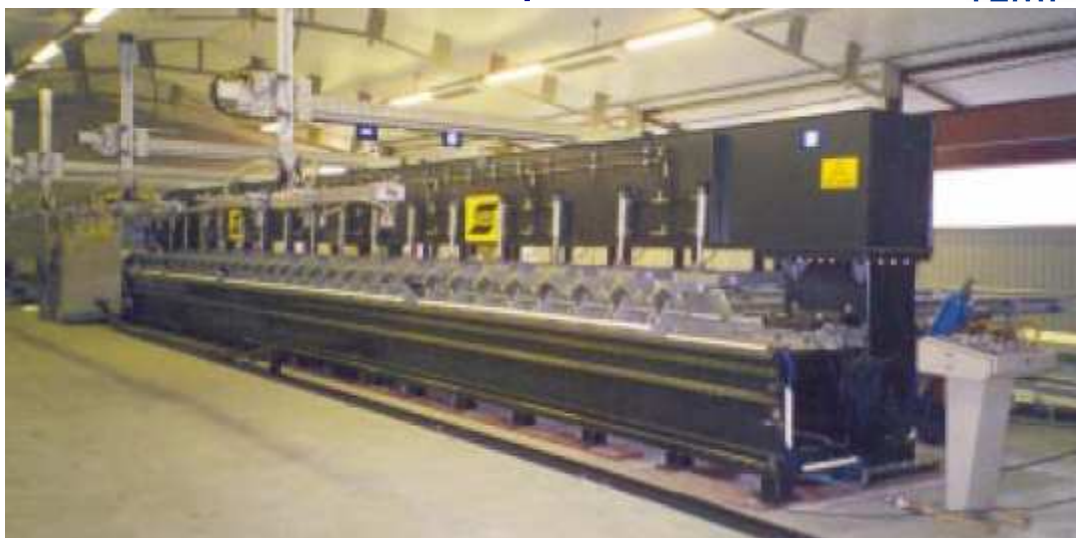
Slika 4.5. Mašina za zavarivanje postupkom FSW, za duge šavove proizvedena u „ESAB”-u
