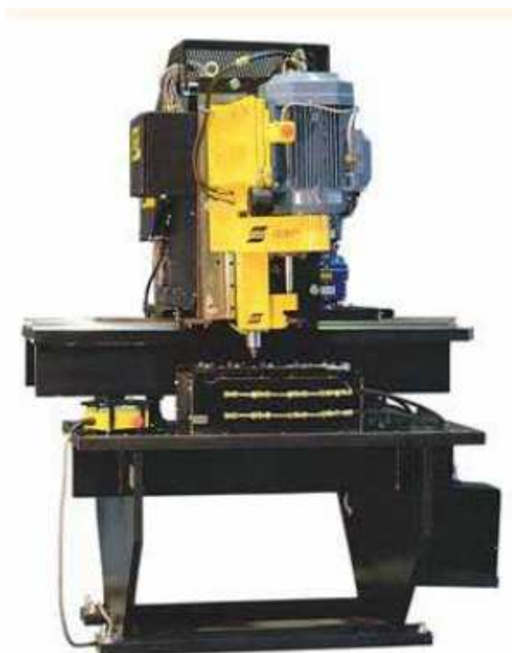
Slika 4.6. Manja mašina za zavarivanje postupkom FSW proizvedena u „ESAB”-u
