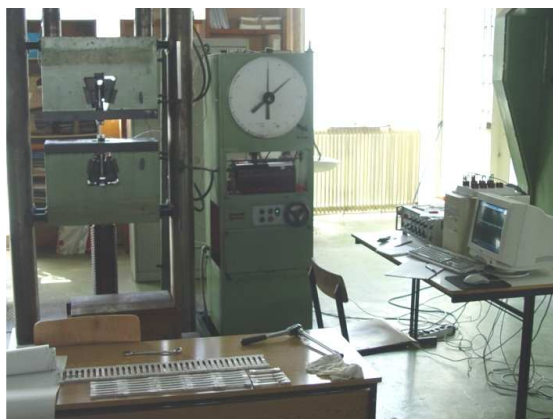
Slika 3.18. Ispitivanje epruveta zatezanjem
