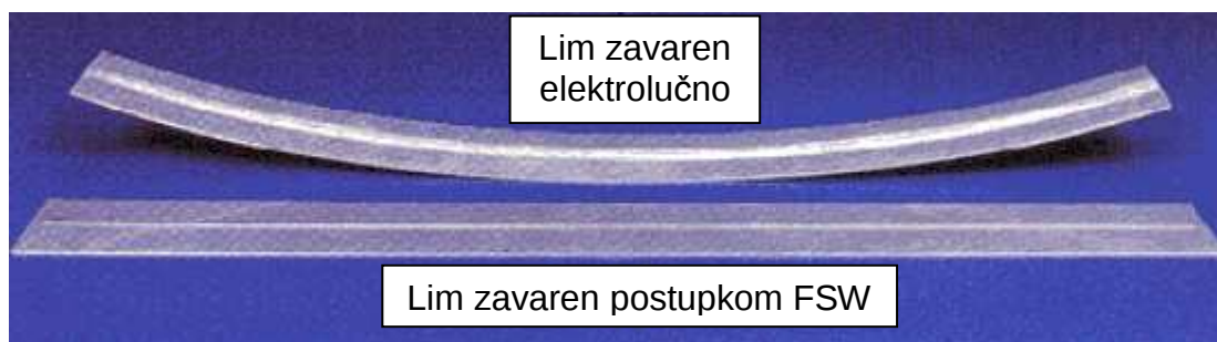
Slika 2.5. Distorzije limova zavarenih elektrolučno i postupkom FSW [3]
