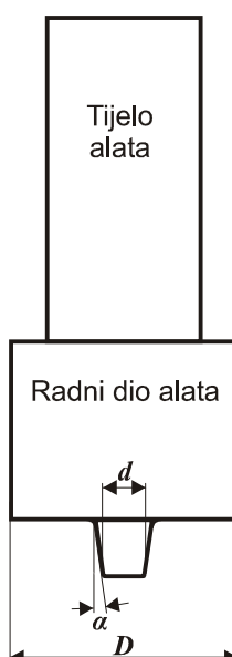
Slika 3.1. Familija alata za proces FSW: D - prečnik čela alata, d - prečnik trna alata i \alpha - ugao nagiba trna alata
