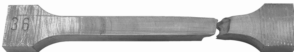
Slika 3.17. Istegnuta epruveta, isječena iz x - pravca
