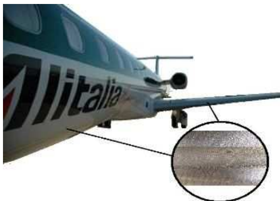
Slika 4.3. Zavarivanje trupa aviona Slika 4.4. Zavarivanje rezervoara rakete korišćenjem postupka FSW [17] korišćenjem postupka FSW [17]
