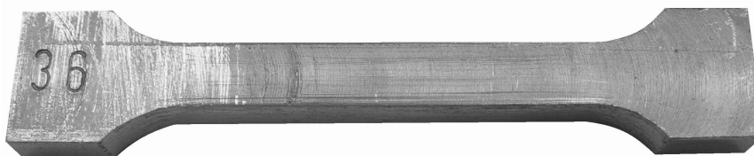
Slika 3.15. Uzorak (epruveta), x - pravac koji se poklapa sa pravcem zavarivanja
