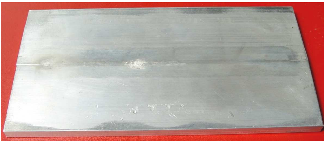
Slika 3.8. Izgled zavarenog spoja sa donje strane zavarenih radnih komada, u centralnoj tački plana
