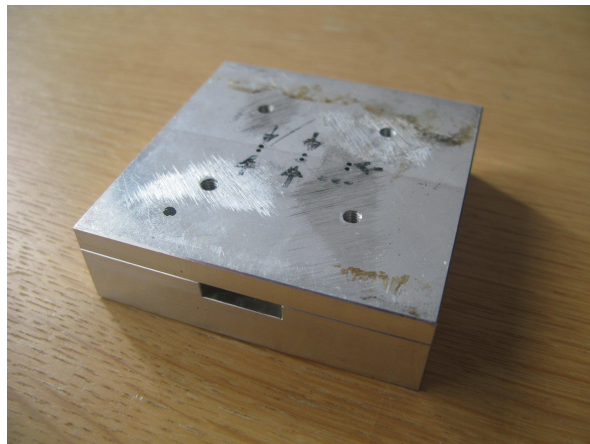
Kalup za izradu silikonskih krakova zaštitne "jakne" elektrode
