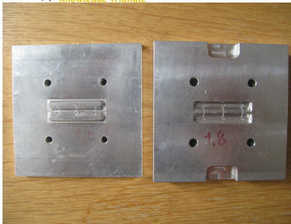
Kalup za izradu silikonskih krakova zaštitne "jakne" elektrode
