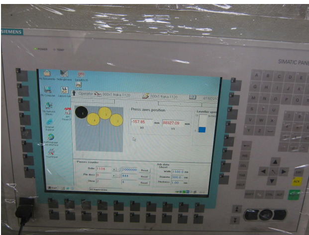
Presa za odsecanje lima koji se koristi za duboko izvlačenje posuđa sa softverom za pracenje odsecanja
