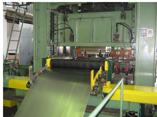
Presa za odsecanje lima koji se koristi za duboko izvlačenje posuđa sa softverom za pracenje odsecanja
