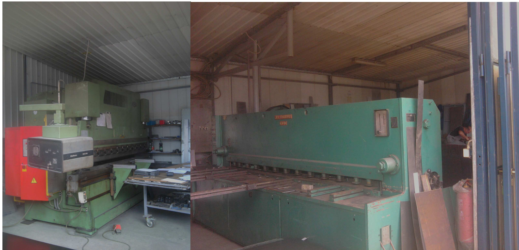
Slika 6. Prese ( abkant i presa za odsecanje lima)
