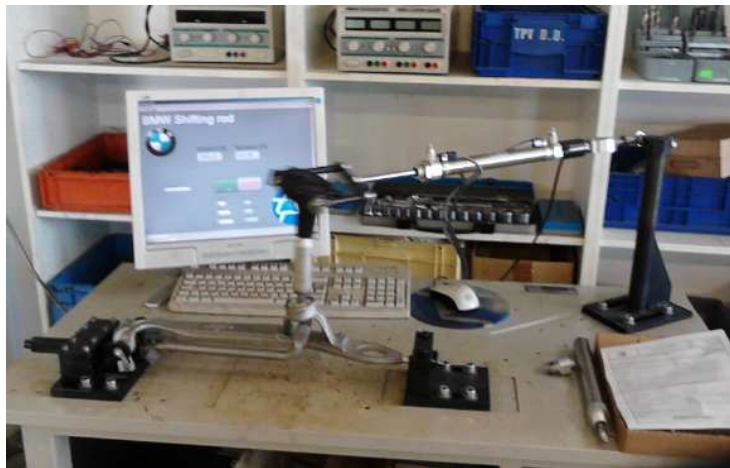
Slika 16. Ispitivanje poluge menjača automobila marke BMW
