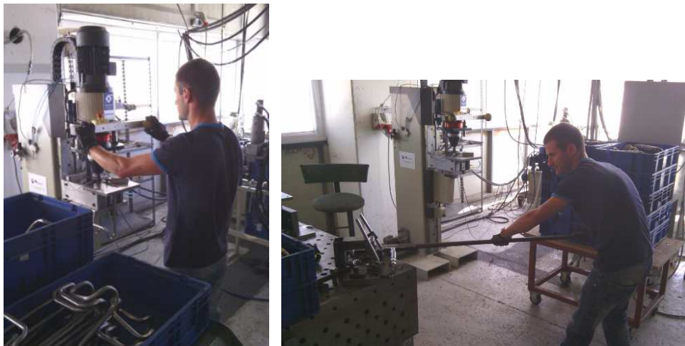
Slika 7. Rad u laboratoriji za izradu prototipova, zaobljivanje ivica tehnikom orbitalnog kovanja (levo), savijanje na profilisanom alatau (desno)
