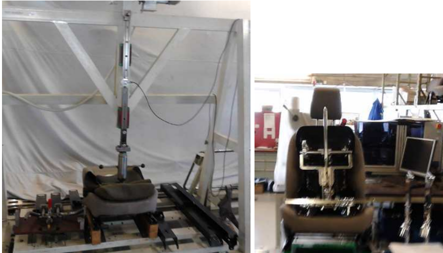
Slika 18. Ispitivanje izdržljivosti prototipa prednjeg automobilskog sedišta
