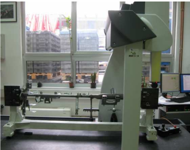
Slika 9. Pogon u Velikoj Loki i izgled koordinatne merne mašine (prikaz dole – levo)
