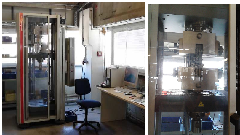
Slika 17. Ispitivanja mehaničkih osobina na "kidalici" marke Zwick
