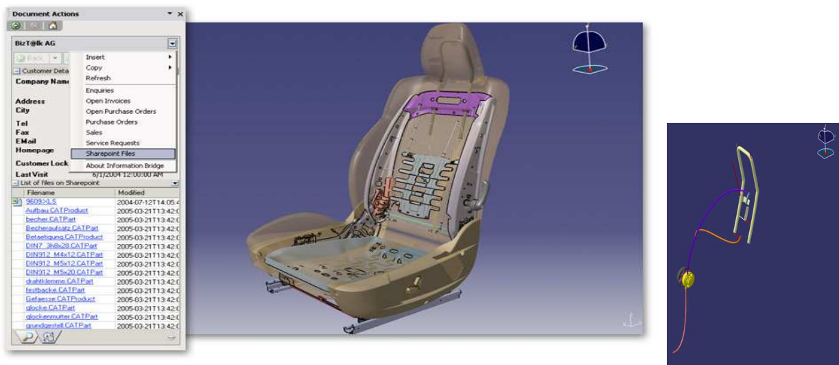
Slika 5. Automobilsko sedište i sistem mehaničkog podešavanja naslona glave
