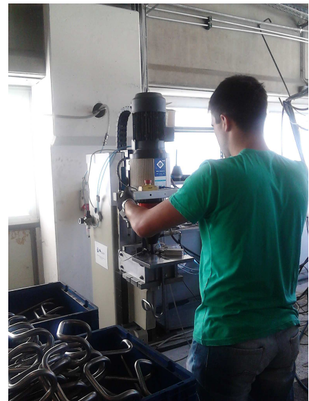
Slika 12, rotaciona mašina za „pertlovanje“ i rad na mašini
