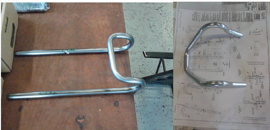
Slika 19, izrađeni prototipovi naslona za glavu u prototipskom odeljenju
