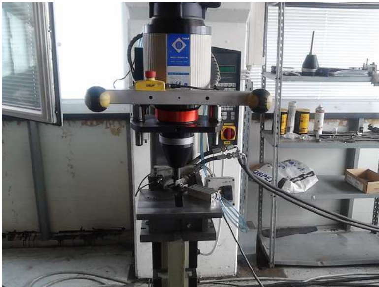
Slika 12, rotaciona mašina za „pertlovanje“ i rad na mašini
