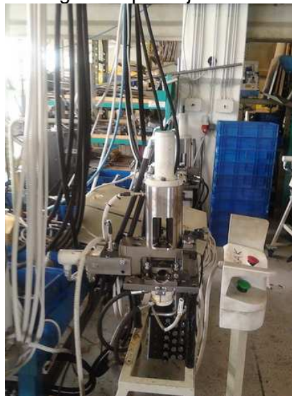
Slika 11, pneumatska mašina i alata za urezivanje rebra
