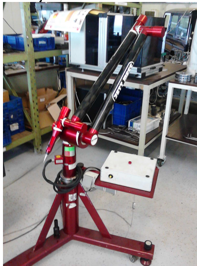
Slika 13, koordinatna ručna merna mašina u prototipnom odeljenju
