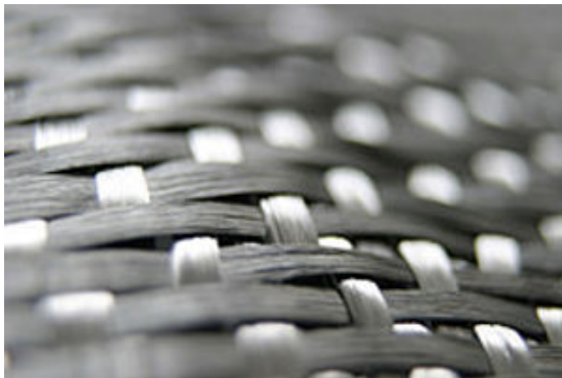
Slika 6.: Ukrštena struktura karbonskih vlakana (tkanina)
