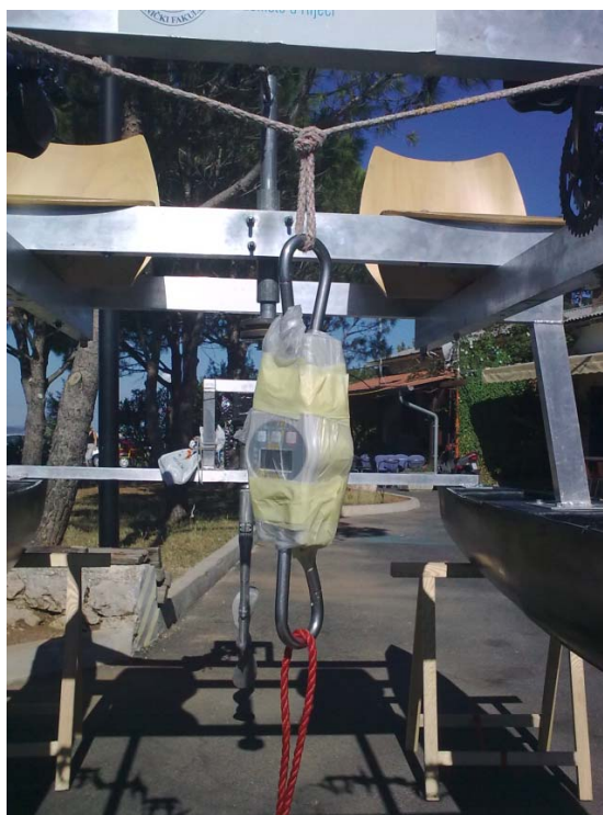
Slika br.17. Testiranje otpora vodocikla uz pomoć dinamometra
