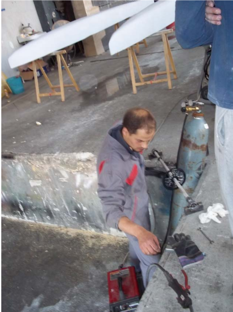
Slika br.10. Zavarivanje lančanika za osovinu
