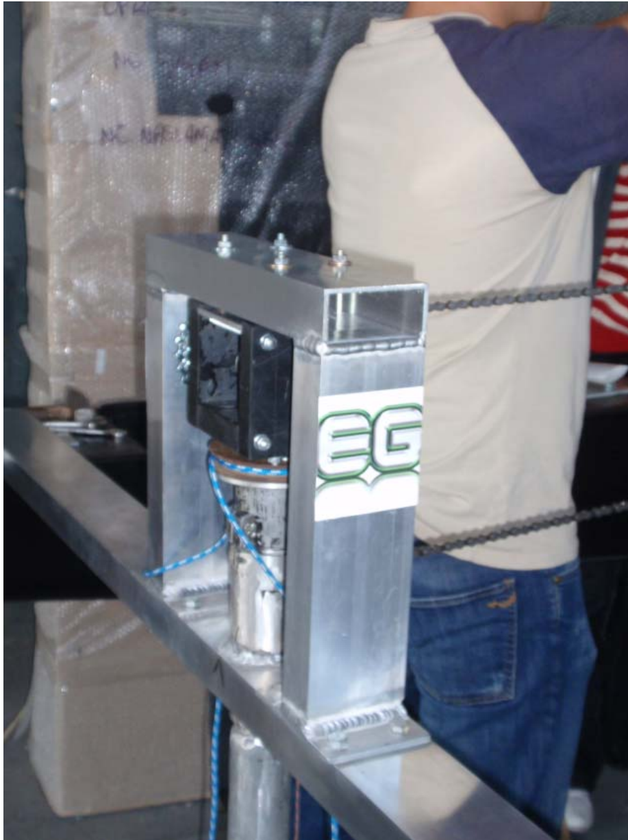
Slika br.14. Prijenosna kutija i remenica unutar U-profila
