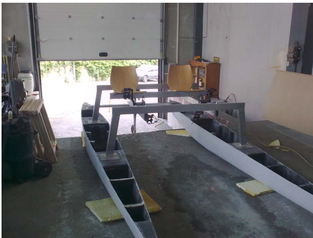
Slika br.11. Konstrukcija spojena sa trupovima
