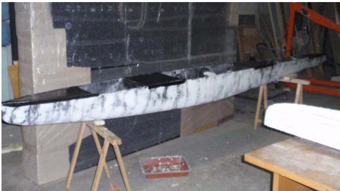
Slika br.6. Nosači (crne boje) postavljeni na poprečna ojačanja
