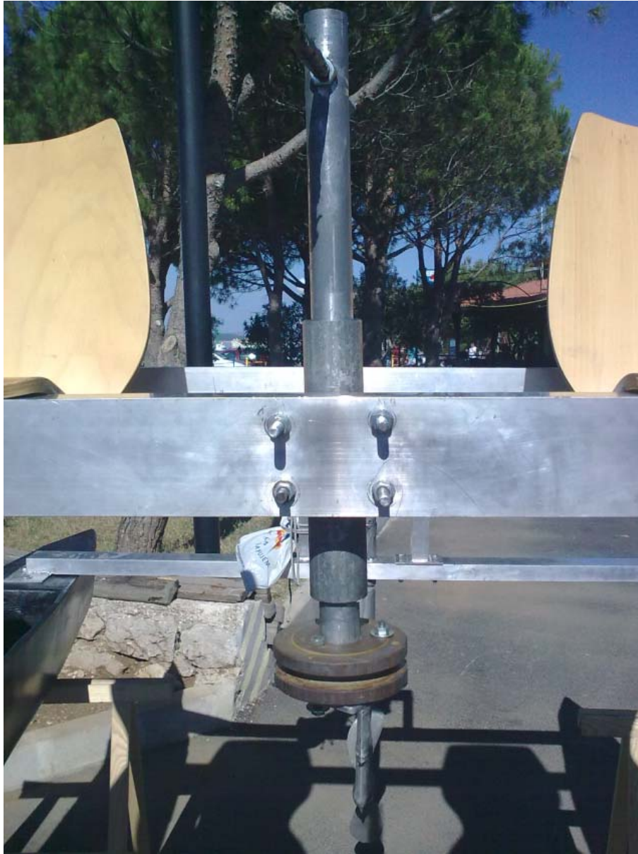
Slika br.13. Kormilo postavljeno na uzdužnom profilu
