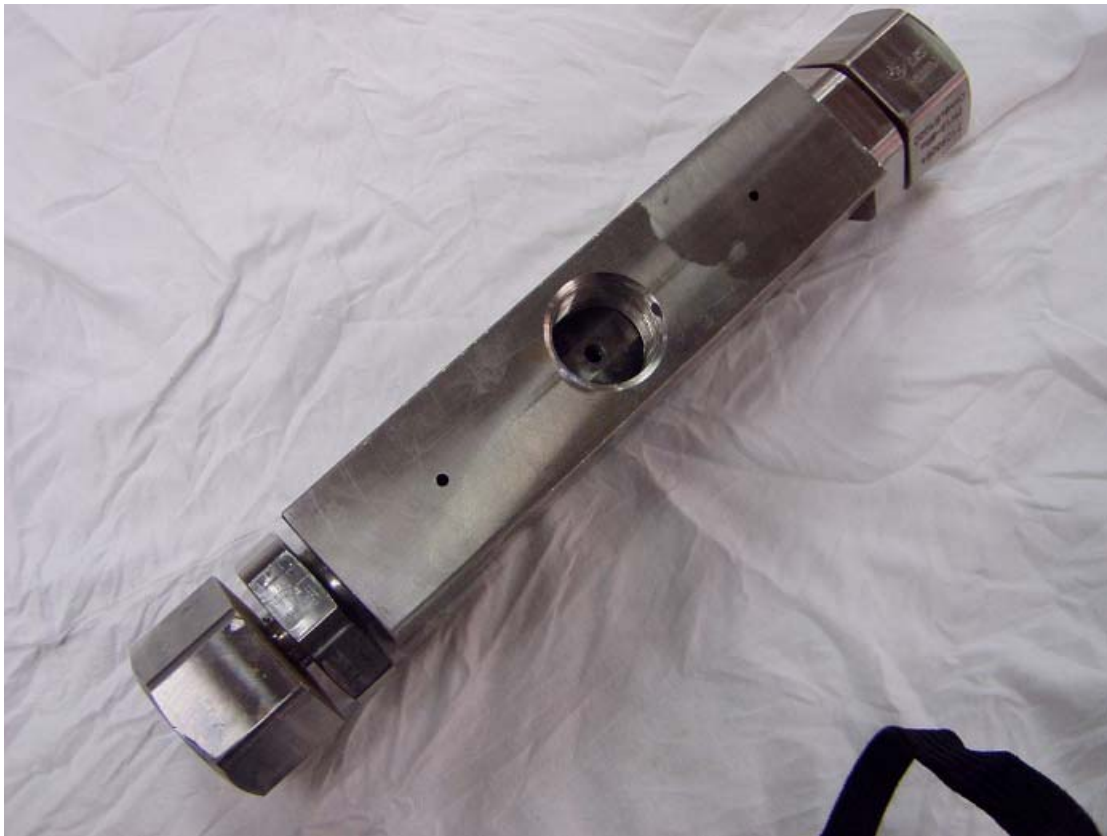
Slika 8: Nepovratni ventil (skinut s cilindra)
