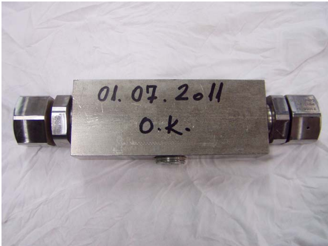
Slika 10: Ventil nakon servisiranja
