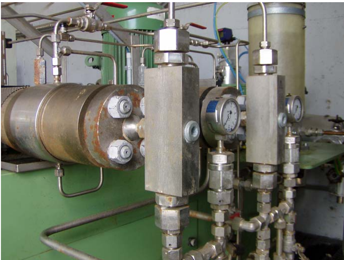
Slika 7: Nepovratni ventil spojen na cilindar
