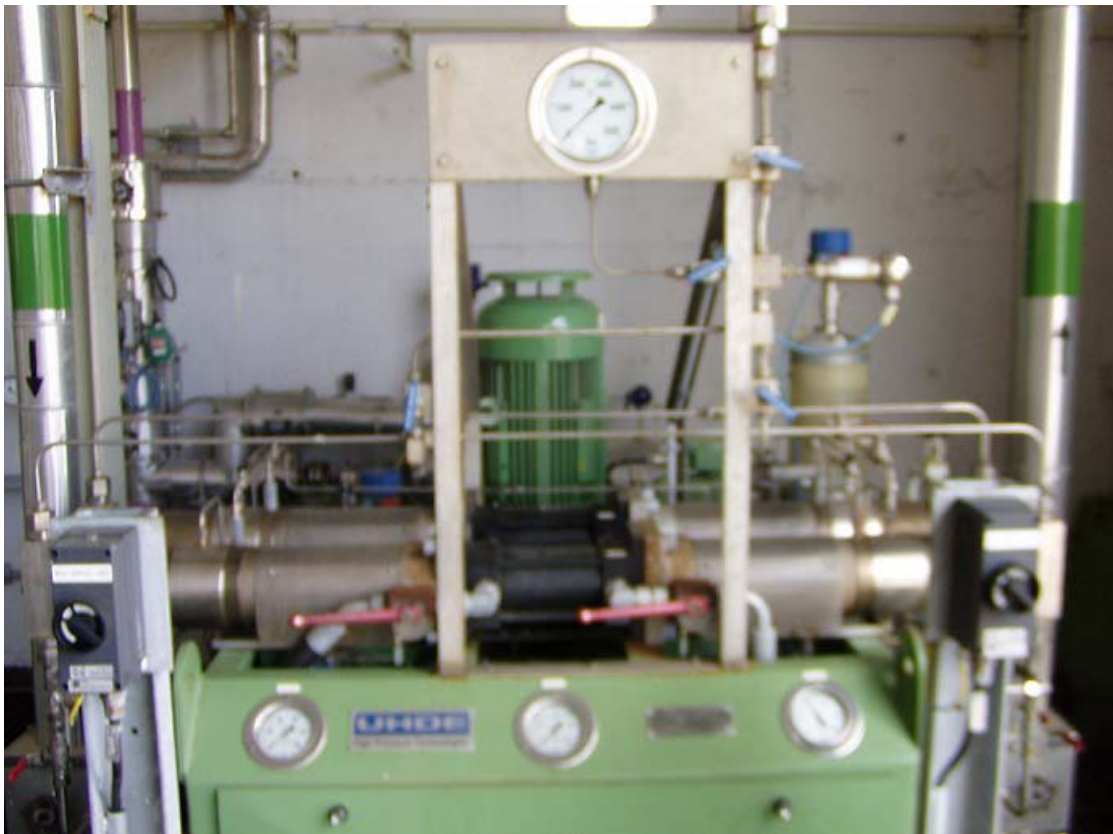
Slika 5: Prikaz analognih pokazivača temperature ulja, tlaka potisa, te radnog tlaka glavnog i kontrolnog hidrauličkog toka
