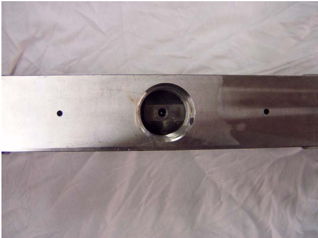
Slika 9: Provrt u sredini nepovratnog ventila
