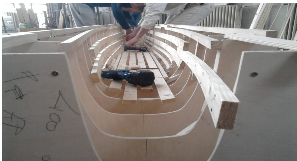
Slika 9 – Postavljanje uzdužnih drvenih letvica
