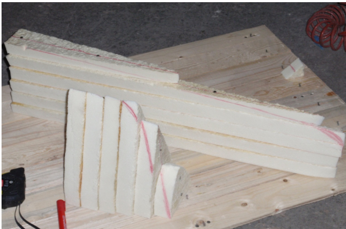
Slika 14 – Izrada pramca i krme od poliuretanskih ploča
