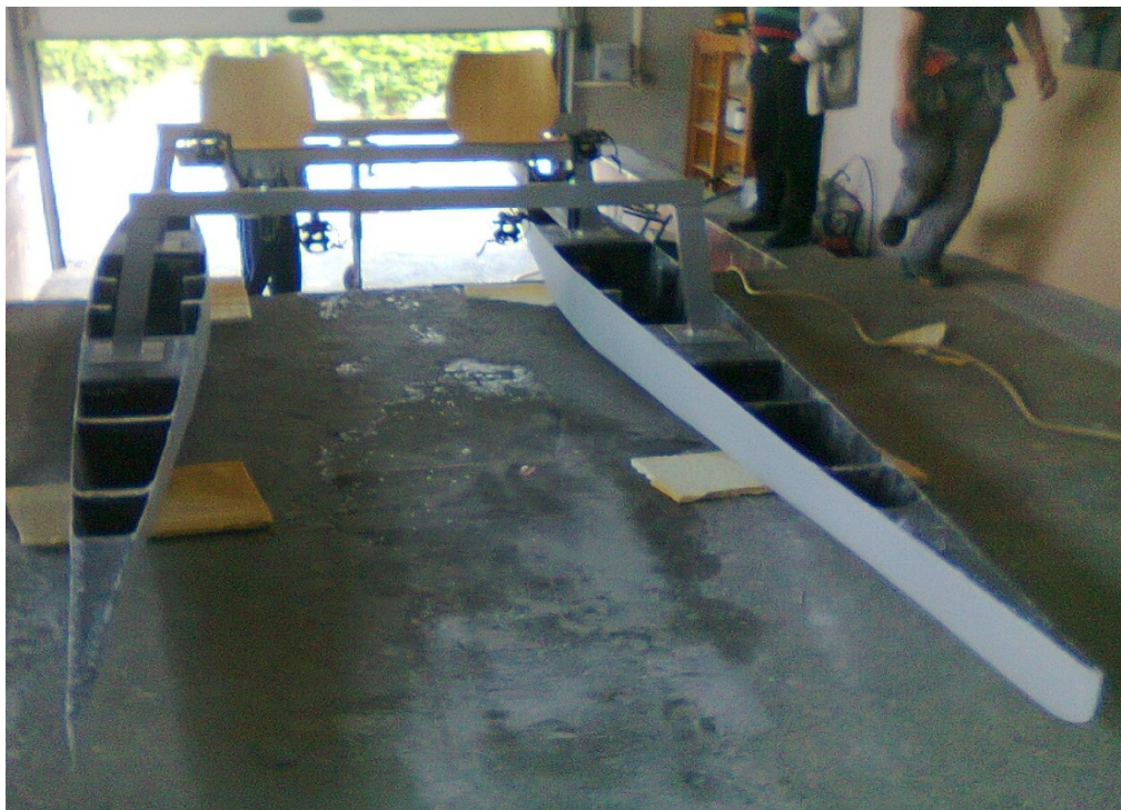
Slika 20 – Vodocikl u završnoj fazi izrade
