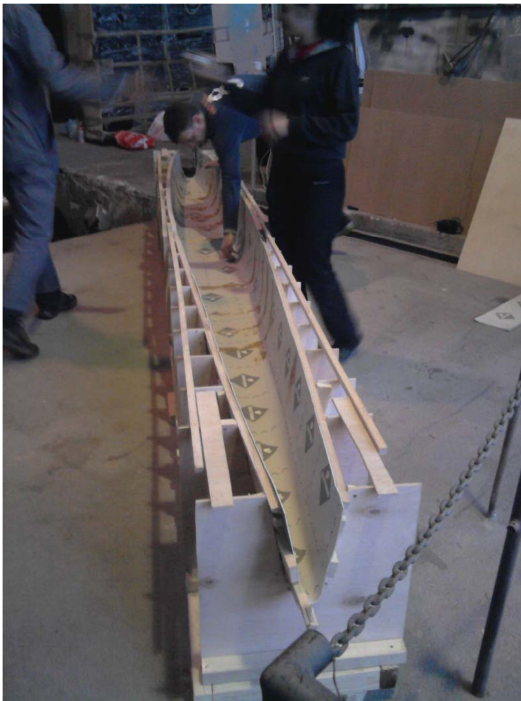
Slika 10 – Kitanje spojeva linoleuma
