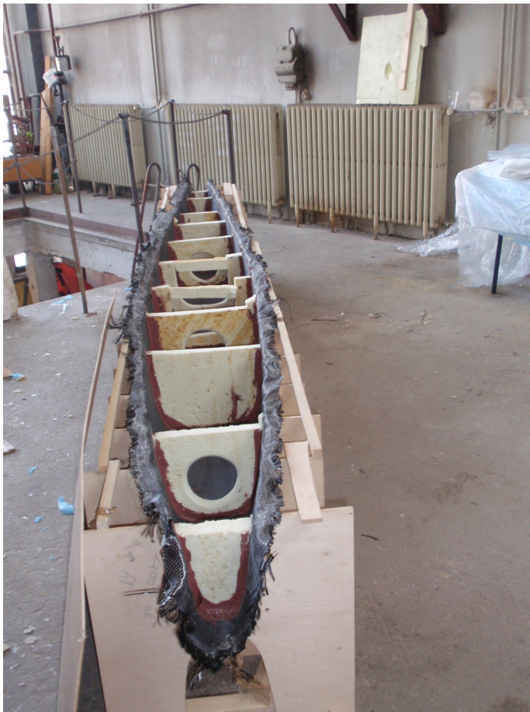
Slika 16 – Ugradnja poprečnih ojačanja trupova
