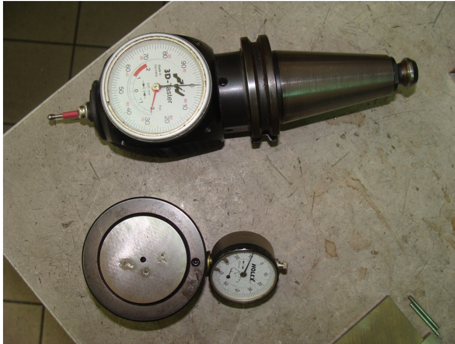
Slika 13. Mjerni uređaji za određivanje visine alata u odnosu na izradak, te nul-točaka izratka
