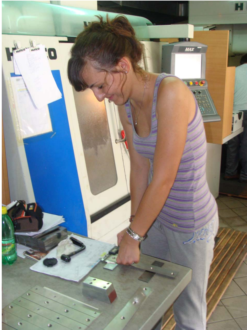
Slika 15. Mjerenje izradaka koristeći kontrolne iglice i pomično mjerilo
