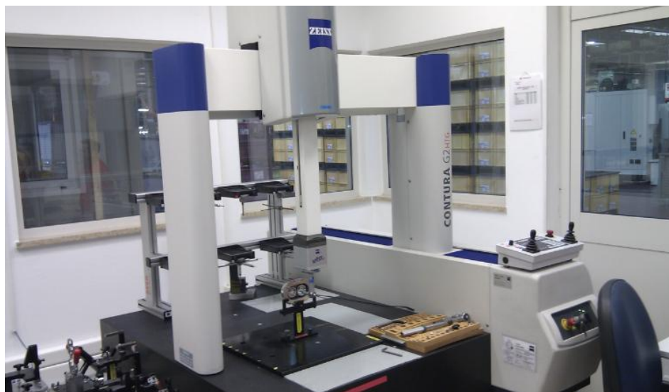
Slika 5.20– Koordinatni mjerni stroj ZEISS u mjernom laboratoriju
