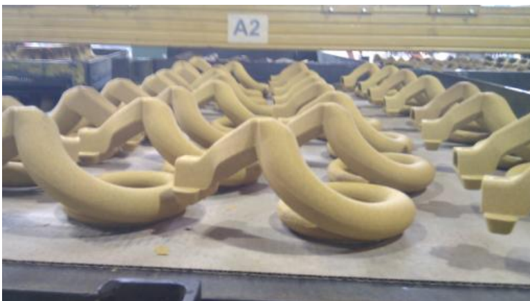
Slike 5.48, 5.49 i 5.50 - Stroj za izradu jezgri SMEC 25, pomična traka s jezgrama te odstajale jezgre na paletama spremne za lijevanje
