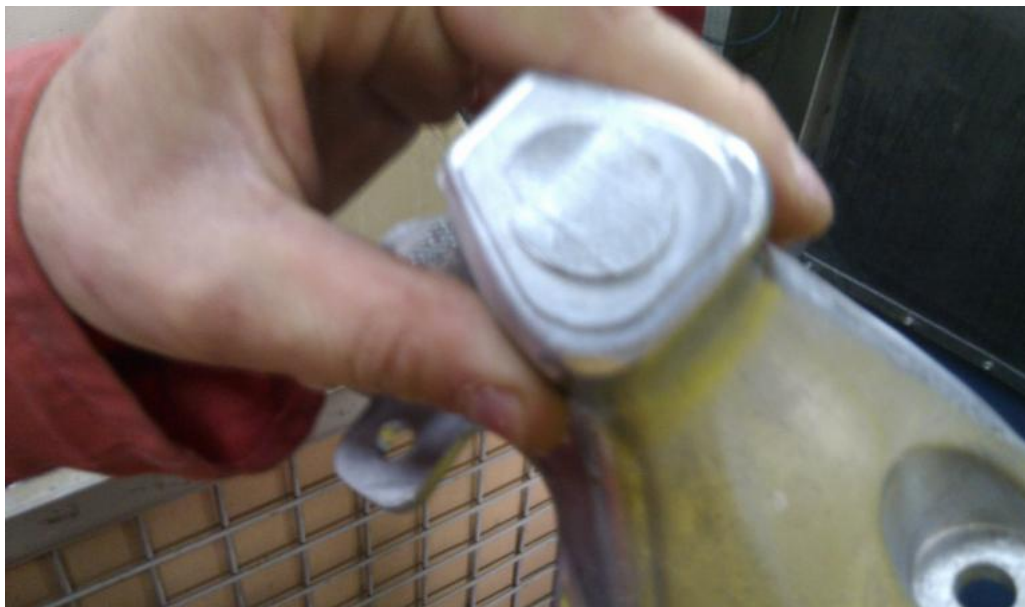
Slika 5.39 – Odljevak s odstranjenim pojilom
