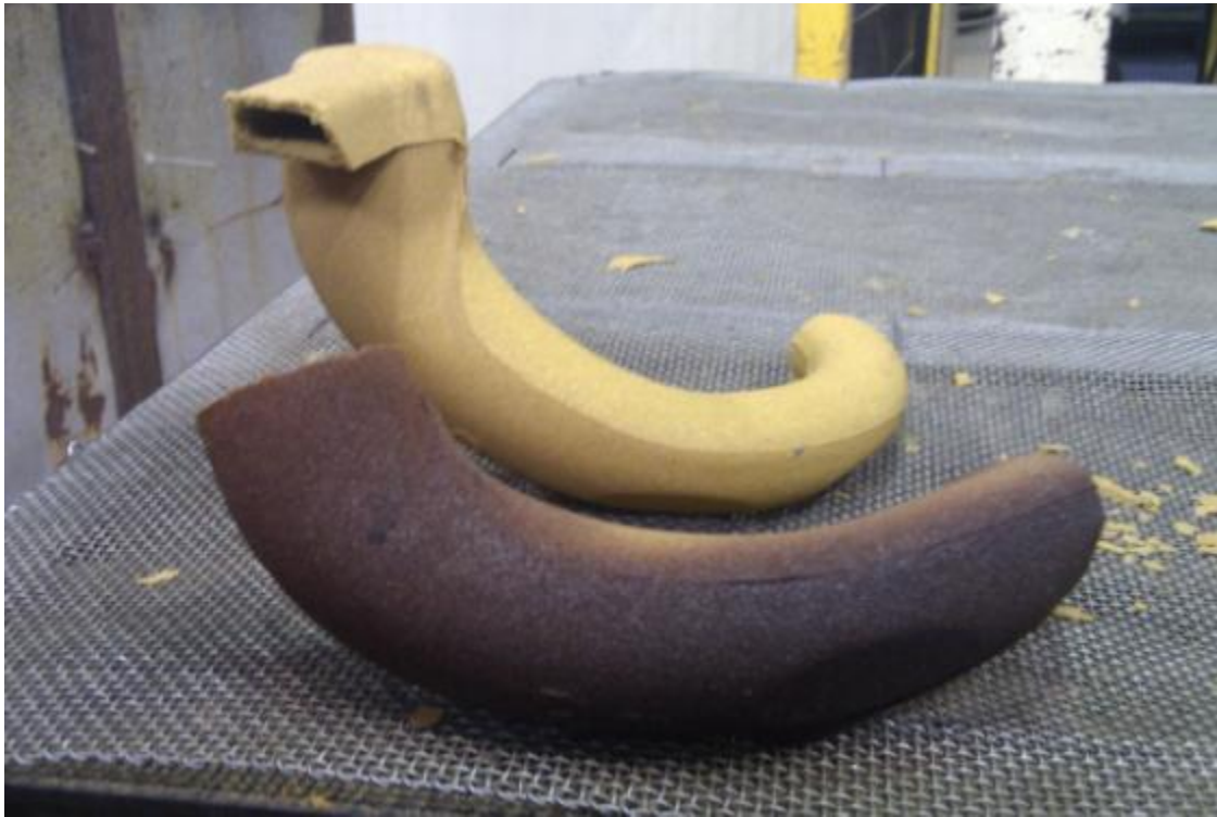
Slika 5.35. – Primjer dobre i loše (prepečene) jezgre
