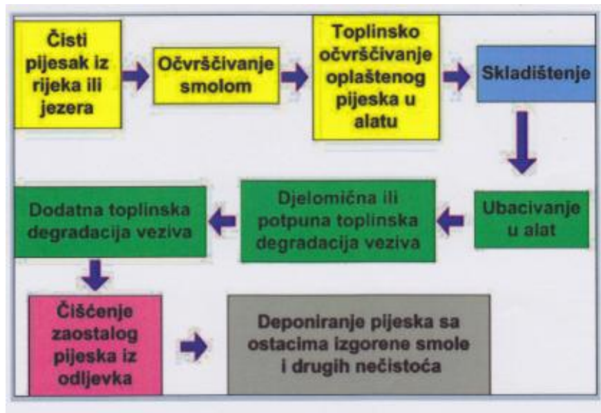
Slika 5.33. – Shema postupka izrade jezgri
