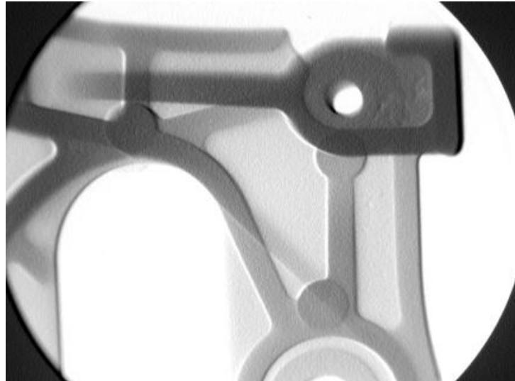
Slike 5.46 i 5.47 – Radni stol uređaja za ispitivanja odljevaka i rendgenska slika tesiranog odljevka
