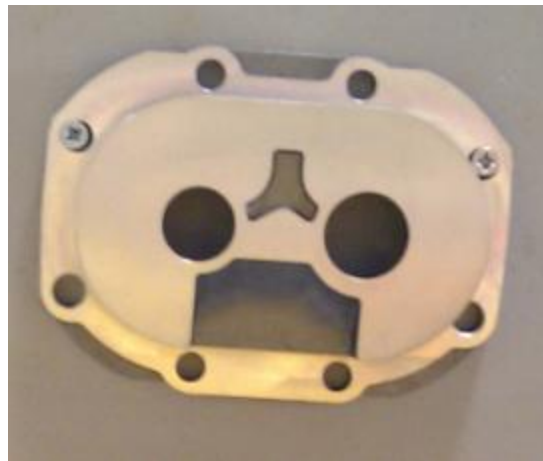
Slika 5.6 – Površina obratka obrađena glodanjem
