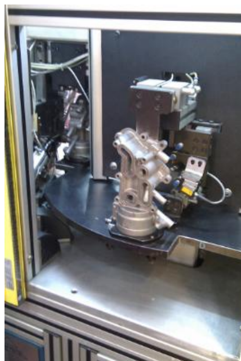
Slika 5.16 – Testiranje komada na nepropusnost
