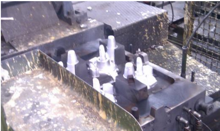
Slike 5.43, 5.44 i 5.45 – Čaša napunjena talinom, odljevci s uljevnim sustavom netom prije degrapiranja te izliveni odljevci u donjoj kokili nakon završenog procesa lijevanja
