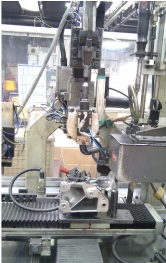
Slike 5.17, 5.18 i 5.19 – Stroj za zakivanje, nosač motora i aluminijska termo armatura za nosač motora
