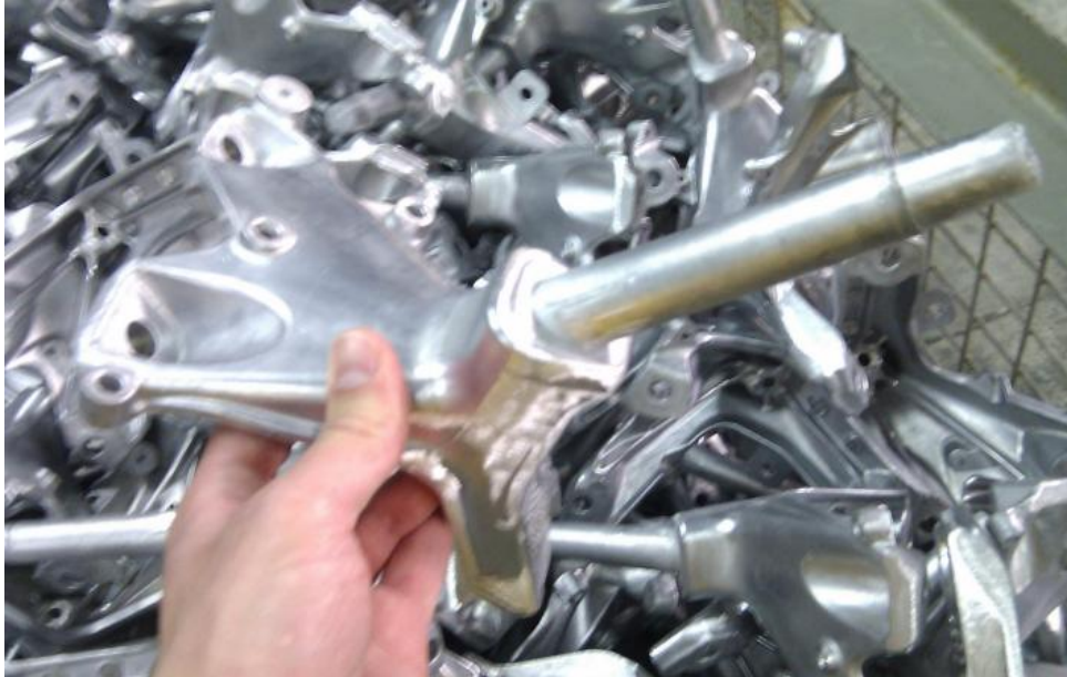
Slika 5.38 - Odljevak s pojilom
