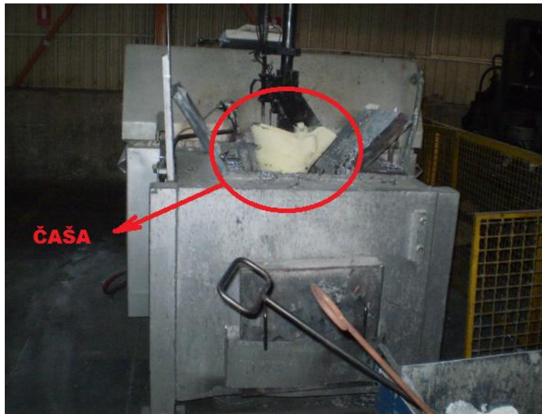
Slika 5.36 – Peć za održavanje temperature STRIKO
