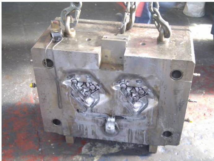
Slika 5.28. - Polovica kokile u proizvodnom pogonu P.P.C.-a Roč
