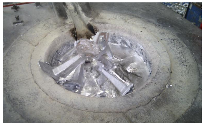
Slike 5.41 i 5.42 – Ručno ubačeni kružni materijal pomiješan s aluminijskim ingotima netom nakon ubacivanja i pri početku taljenja u peći
