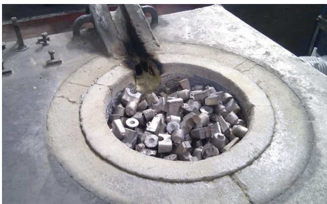
Slike 5.41 i 5.42 – Ručno ubačeni kružni materijal pomiješan s aluminijskim ingotima netom nakon ubacivanja i pri početku taljenja u peći
