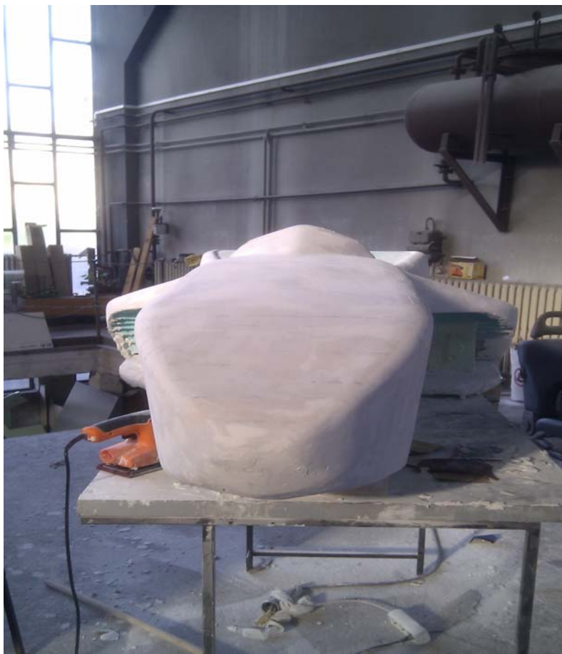
Slika 19 – model u fazi gipsanja i brušenja
