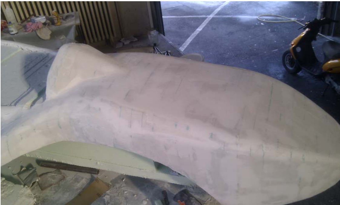
Slika 11 – model sa više slojeva kita i gipsa
