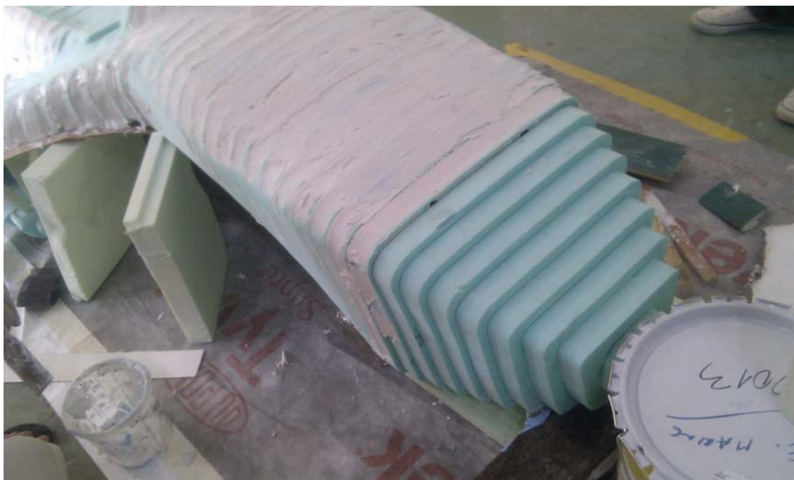
Slika 18 – model u jednoj od fazi kitanja
