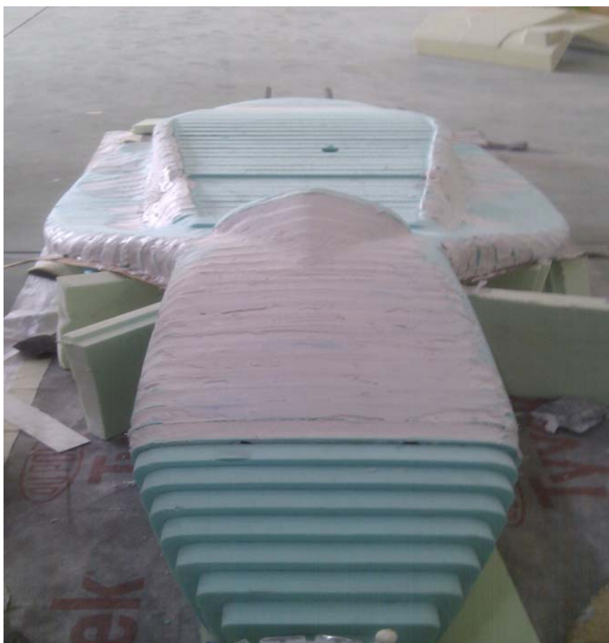
Slika 17 – model u jednoj od fazi kitanja
