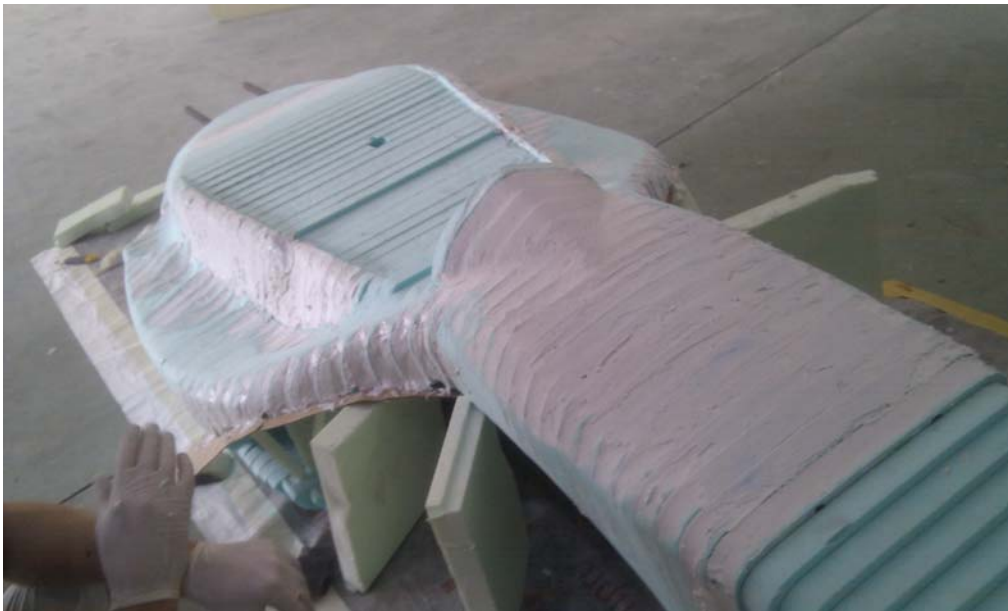
Slika 10 – model sa prvim slojem kita
