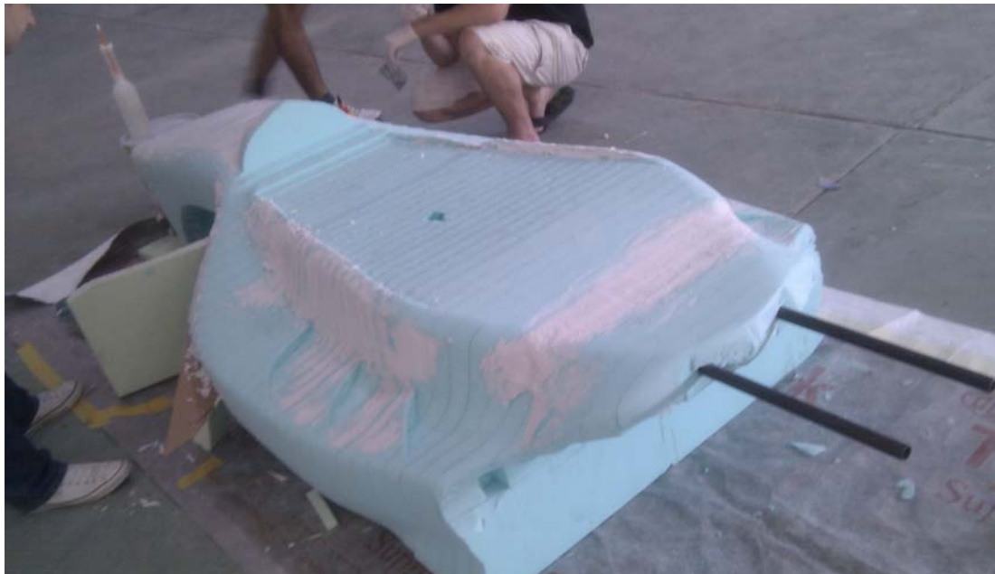
Slika 16 – model u jednoj od fazi kitanja
