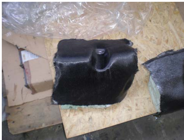
Slika 18: Laminacija zaštite amortizera
