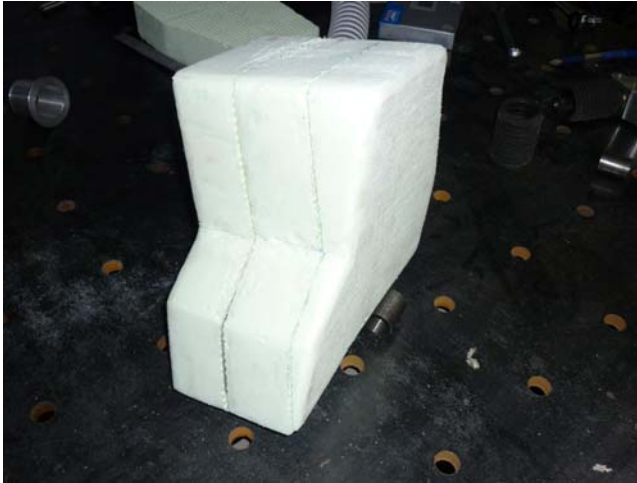
Slika 11 i 12: Model od stiropora sa i bez priključaka za gorivo
