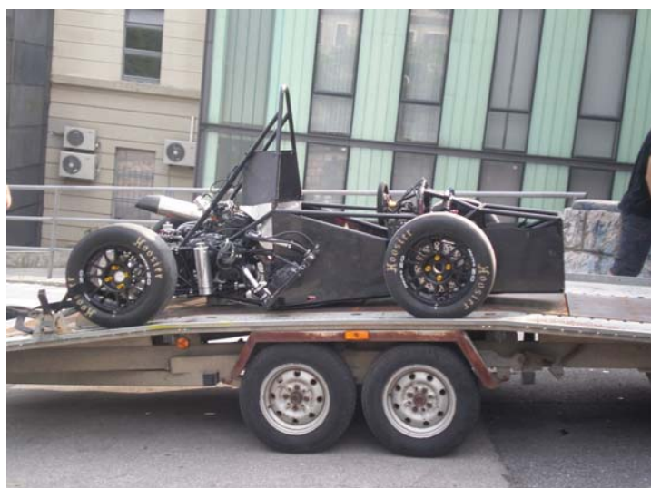
Izrezane i montirane bočnice i firewall
