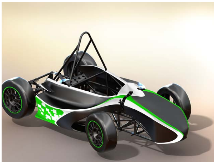
Slika 8: CAD model bolida RRC11
