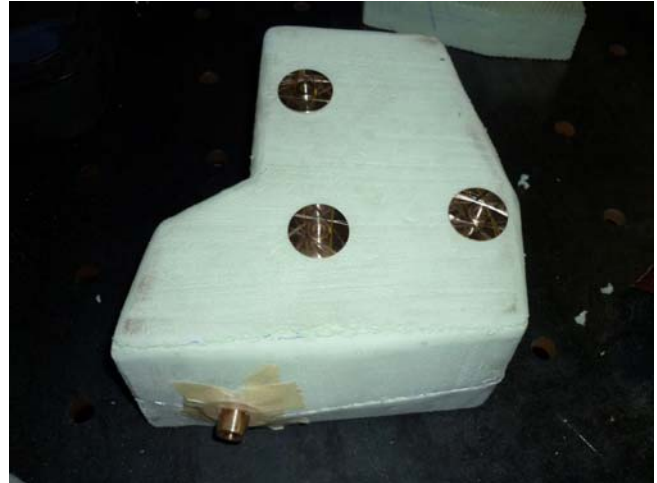
Slika 11 i 12: Model od stiropora sa i bez priključaka za gorivo
