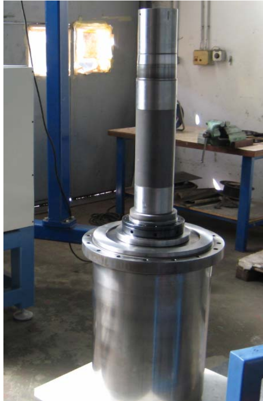
Vreteno u kojemu se nalaze ležajevi i bez glavnog motora.
