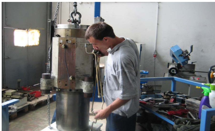
Ja u postavljanju hidrauličkih cijevi na vretenik
