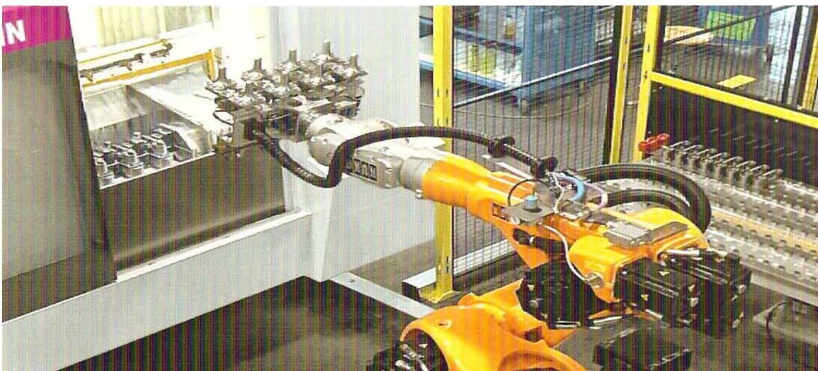
Prikaz robotske ruke koja uzima obrađeni komad iz stroja te je stavlja na paletu(desno).
