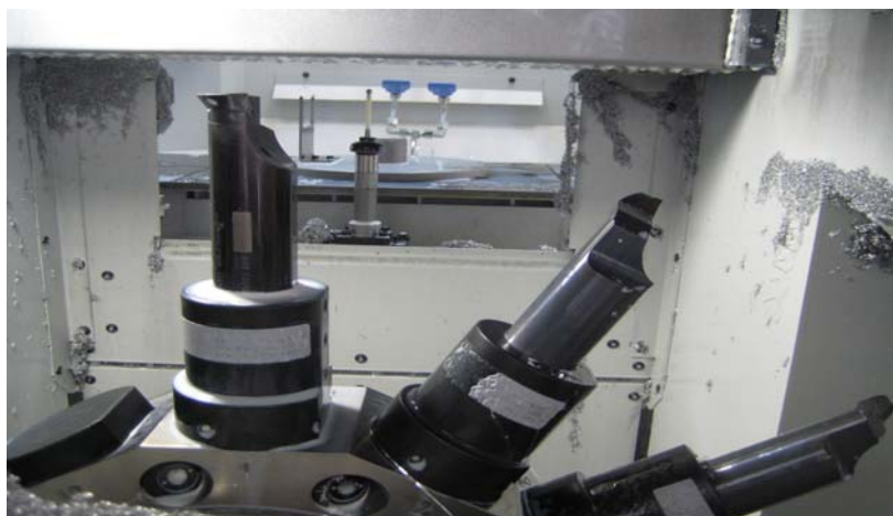
Noževi kojima se vrši obrada te otraga vidimo mjerni sistem kojim se vrši mjerenje referentnih dimenzija obradaka unutar stroja
