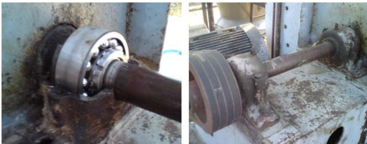
Slika 22. a) Montaža novog ležaja, b) Sastavljen ležajni sklop
