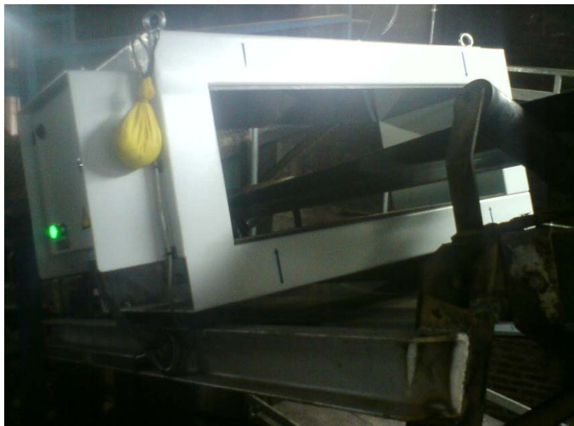
Slika 3. Detektor metala učvršćen na novo navareni nosač
