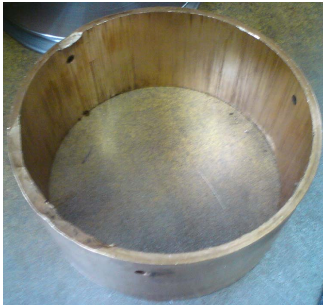
Slika 9. Istrošena klizna čahura
