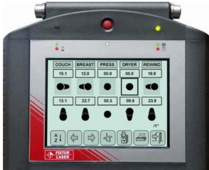
Slika 13. Centralna jedinica s prikazom odstupanja svih valjaka [4]
