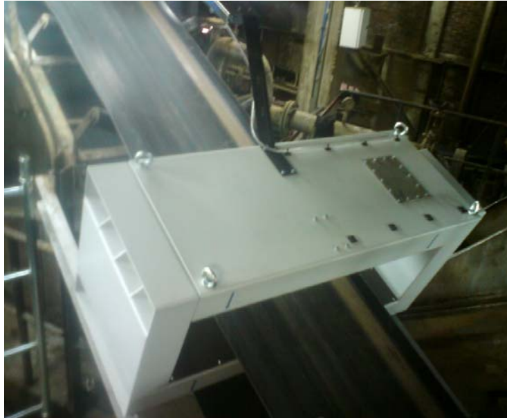
Slika 4. Namješten detektor metala
