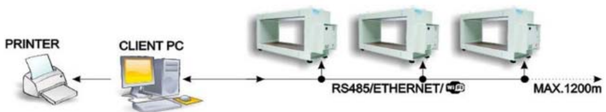
Slika 2. Princip spajanja detektora metala s okolinom [2]
