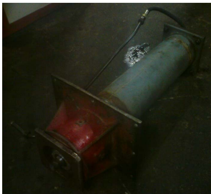
Slika 10. Sklopljeni sekundarni potisni cilindar
