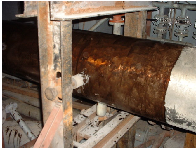
Slika xxx. Privremeni ležaj (POZ 1' i 2' iz proračuna) za centriranje osovinskog voda
