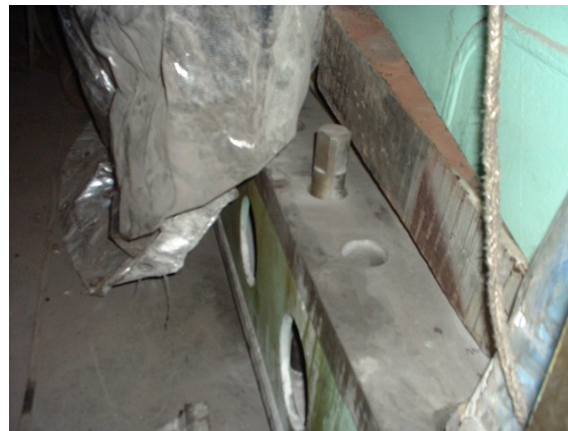
Slika xxx. Vijci na glavnom motoru za vertikalno niveliranje
