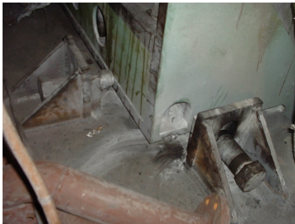
Slika xxx. Privremene upore i vijci za horizontalno centriranje glavnog motora
