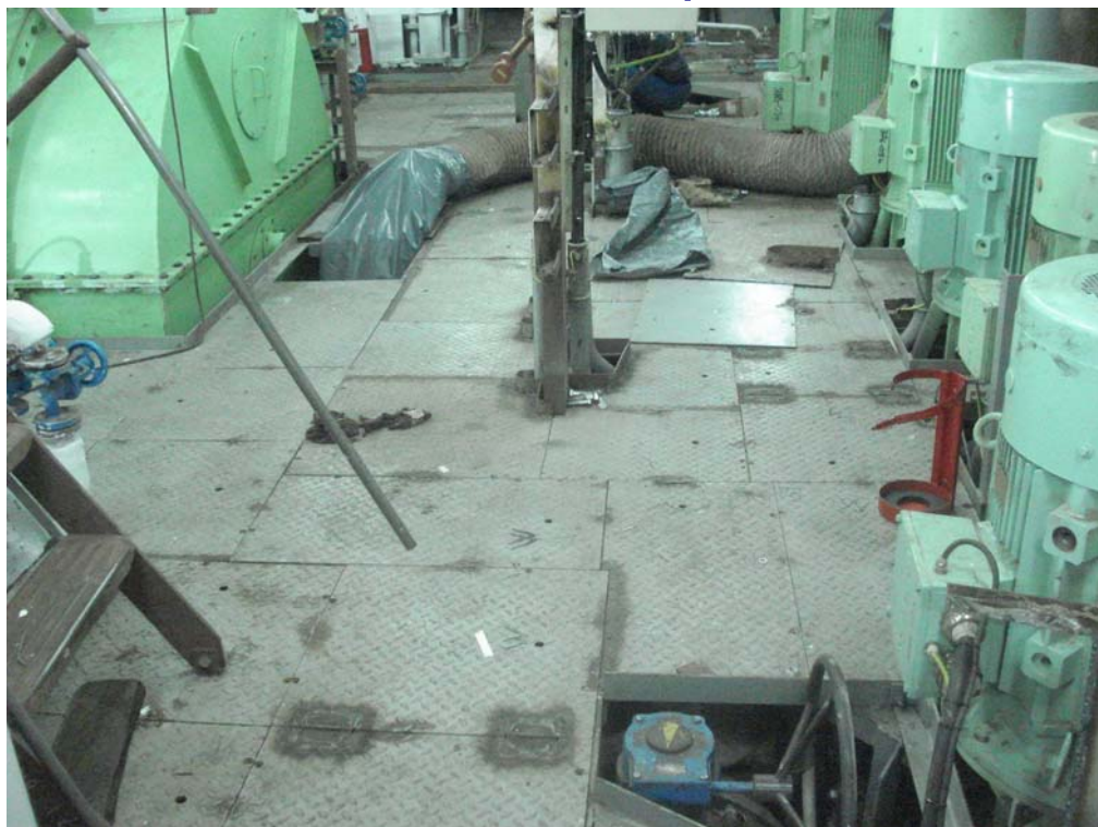
Slika 18.: Kompletno montirana pumpna stanica u strojarnici broda na lijevoj strani slike vidljiv glavni motor MAN 9L 32/40 CD
