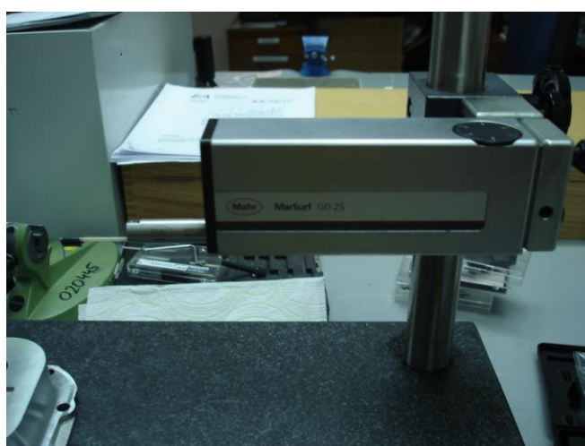
Slika 18. Ticalo za mjerenje hrapavosti i pripadajući nosač
