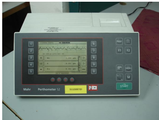
Slika 17. Perthometer, na slici je prikazan ekran za očitavanje dobivenih mjerenja
