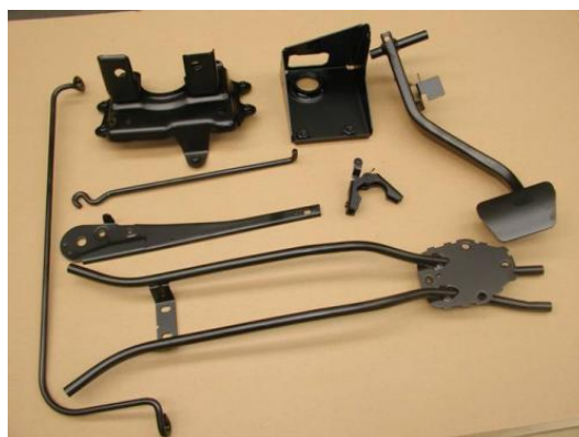
Slika 5. Polužje za izbor brzina
