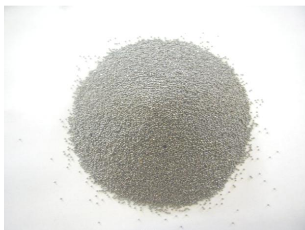
Slika 62. Medij za pijeskanje (mješavina aluminijske sačme i kvarcnog pijeska)
