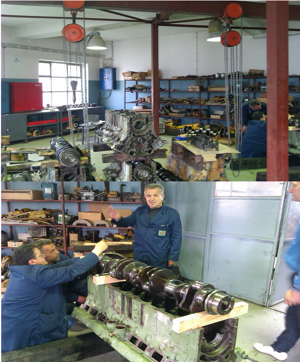
Slika 16 .Remont (generalka) Motora dampera Perlini obrada bregaste osovine
