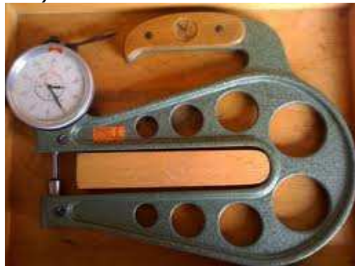
Slika 15. Komparater za mjerenje debljine gume ili lima
