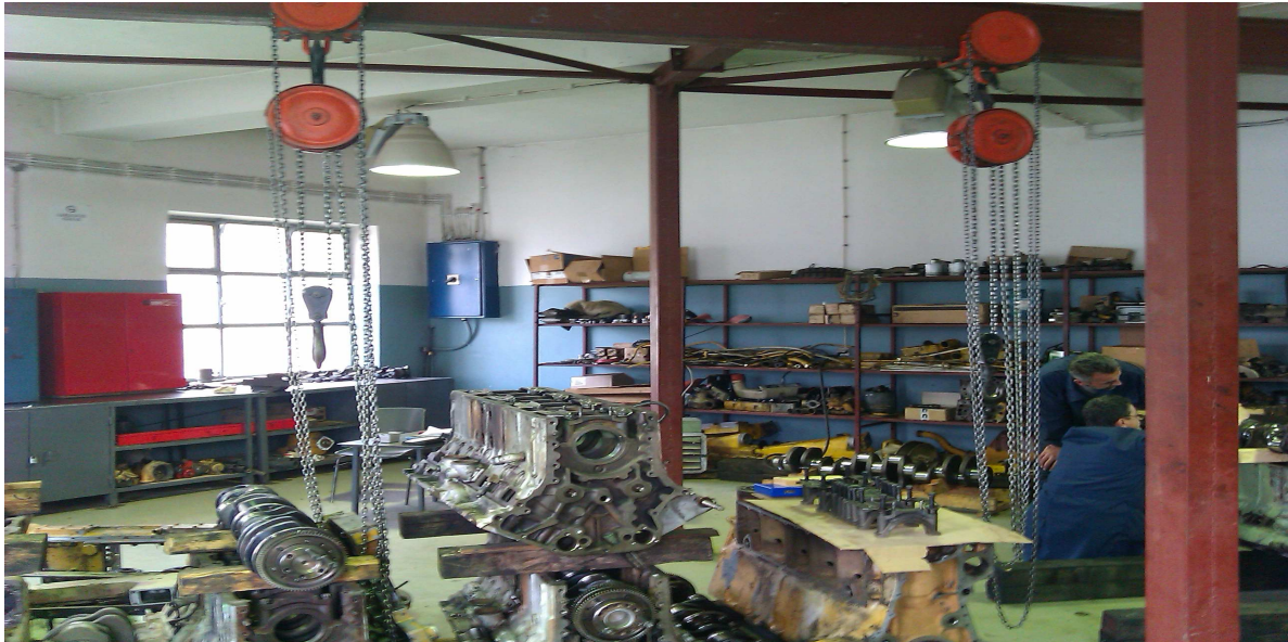
Slika 22 .Remont (generalka) Motora dampera Perlini obrada bregaste osovine
