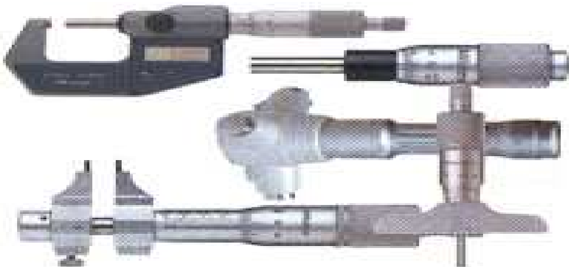
Slika 20. Mikrometar za vanjske mjere, unutrašnje mjere i za mjerenje dubine
