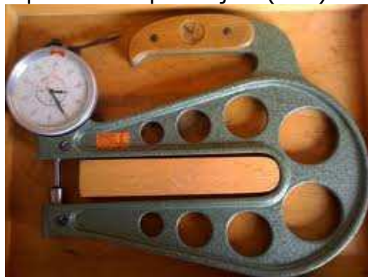
Slika 21. Komparater za mjerenje debljine gume ili lima
