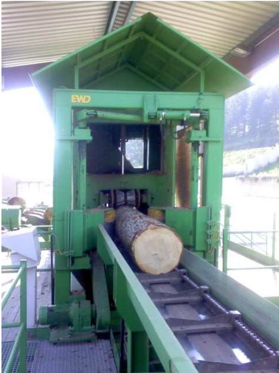
Sl. 2. Uređaj za skidanje kore ER 90 EWD
