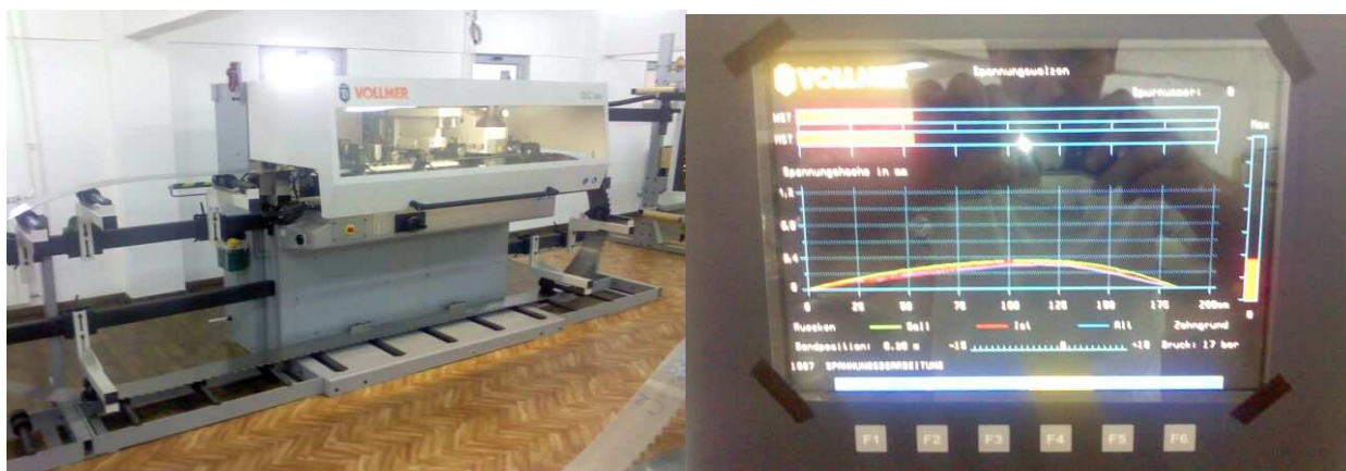
Sl. 28. Mašina za ravnanje testere, sa kompjuterskim prikazom krivoće
