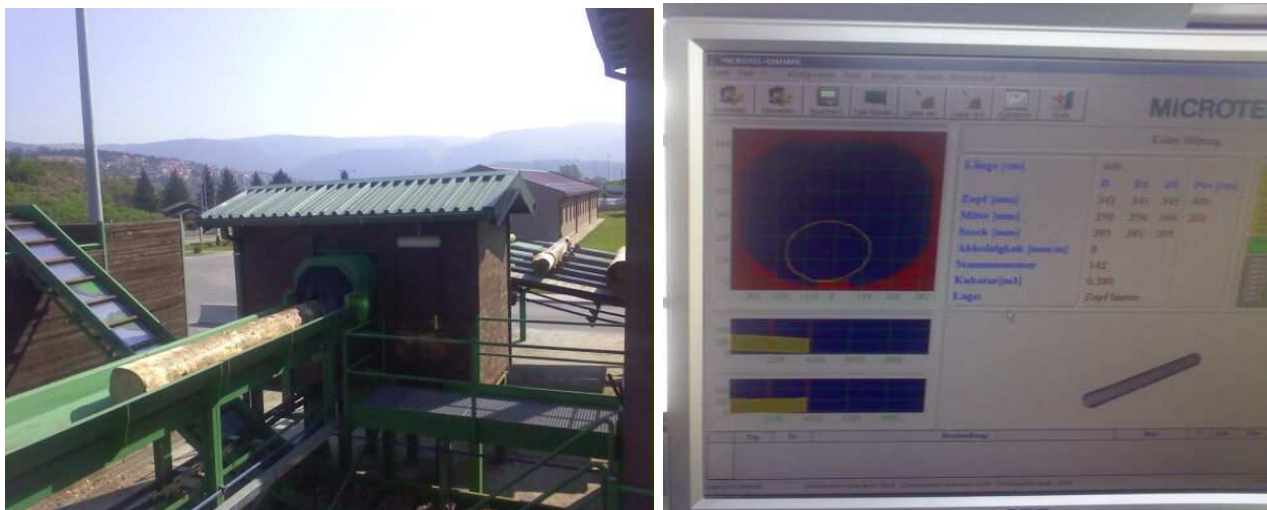
Sl. 3. 3D mjerenje MICROTEC DISHAPE 800
