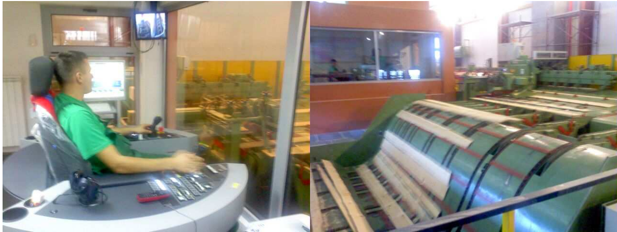
Sl. 17. Linija za uzdužnu i poprečnu obradu dasaka iz dopunske zone – Optimes linija
