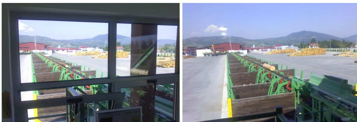
Sl.6. Sortirni transporter sa sortirnim boksovima
