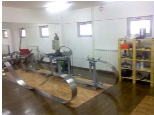
Sl. 31. Argonsko ručno navarivanje
