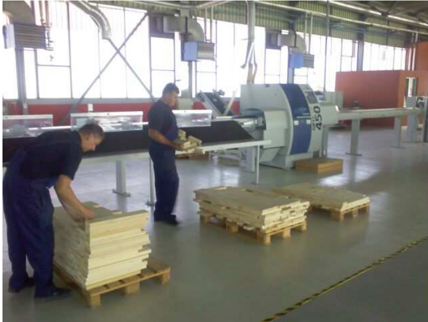
Sl. 43. Rad na optimizirajućoj kratilici Optikus S-450
