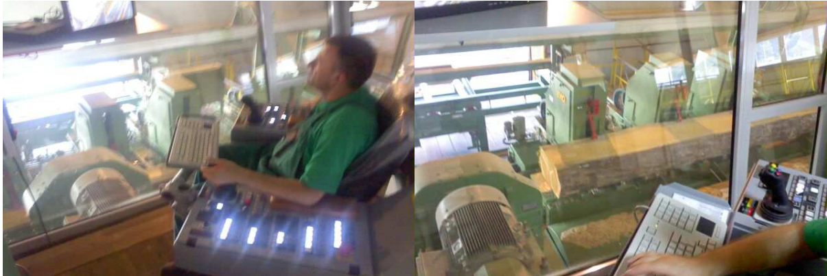
Sl. 15. Upravljačka kabina operatora na tračnoj pili
