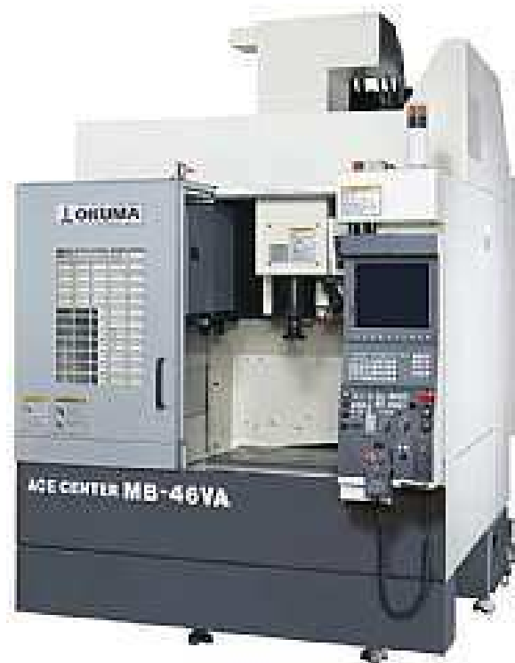
Slika 3. Troosna CNC glodalica OKUMA MB - 46VA
