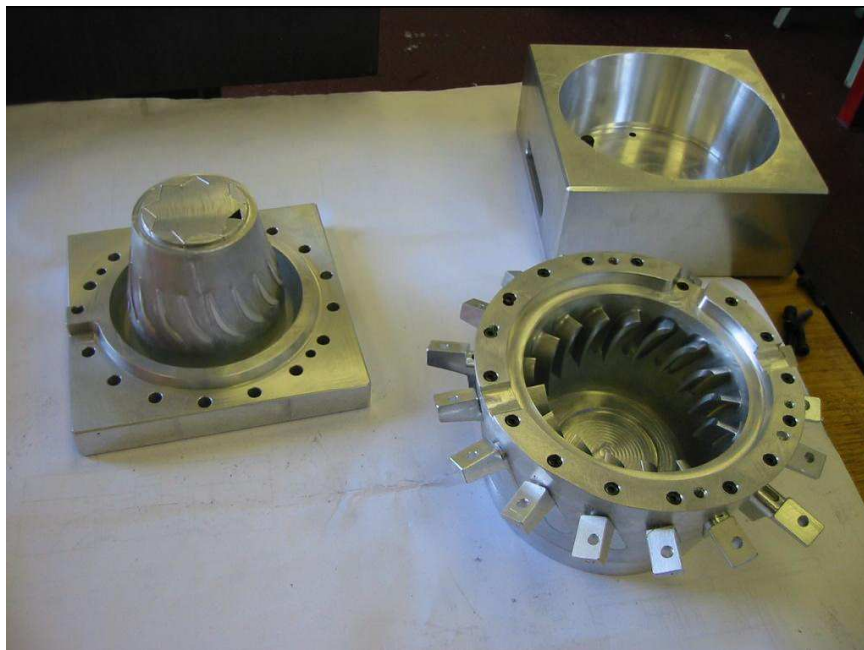
Slika 5. Obratci napravljeni na petosnoj CNC glodalici
