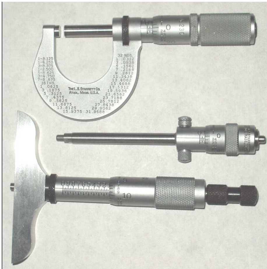
Slika 10. Mikrometri za vanjske mjere, unutarnje mjere i mikrometar za mjerenje dubine
