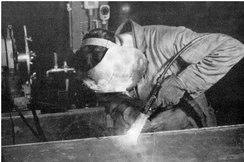
MIG postupak zavarivanja
