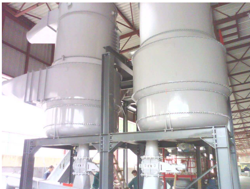
Sl. 53. Montiran uređaja za miješanje i navlaživanje suvog iverja
