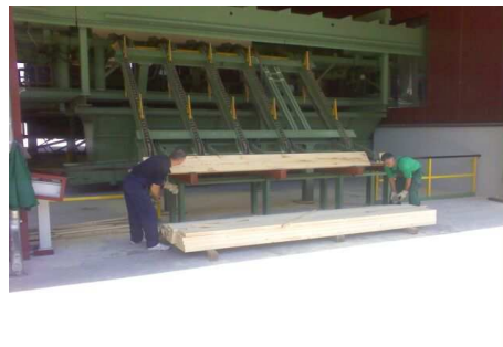
Sl. 42. Poprečni sortirni transporter NQF / S
