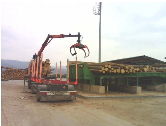
Sl. 23. Dozirna rampa na stovarištu oble građe
