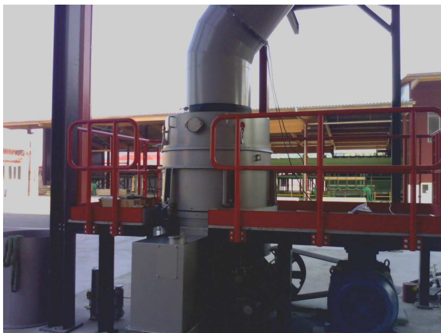
Sl. 48. Montiran mlin sirovog materijala za pelete
