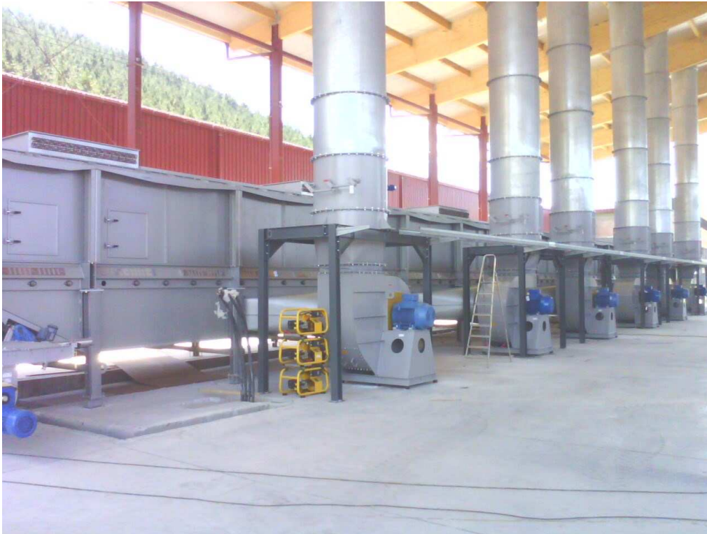
Sl. 6. Sušara za sušenje vlažnog iverja
