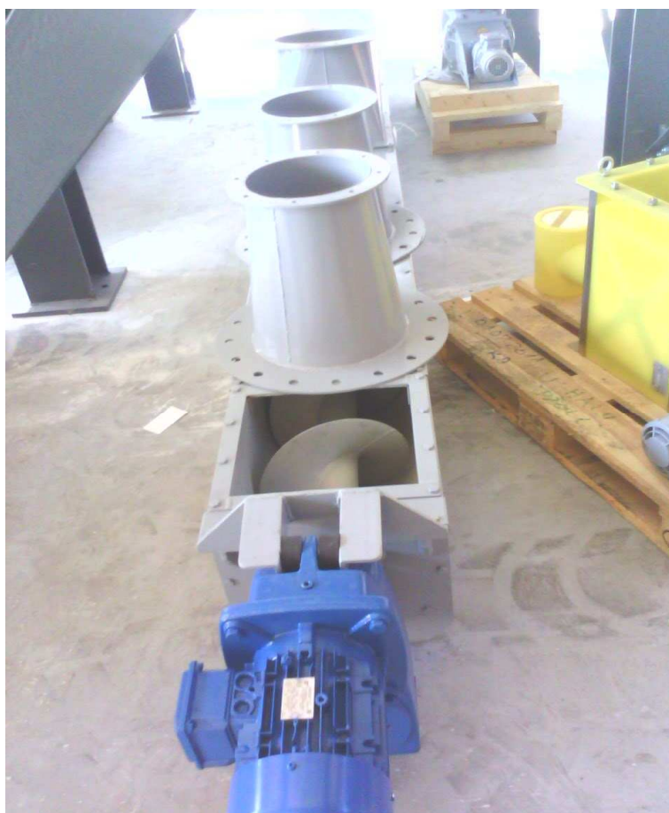
Sl. 15. Montaža pužnog transportera opremljenog uređajem za mjerenje težine
