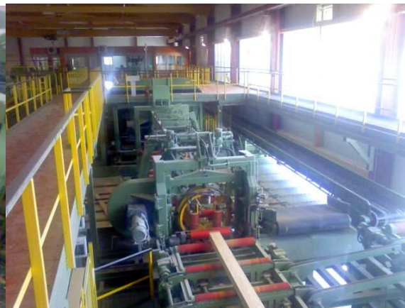
Sl. 36 Kanter sa predrezačima PF19-4/V.
