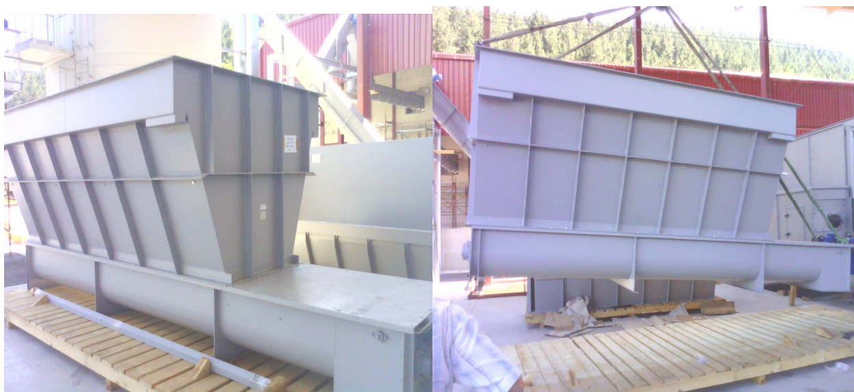
Sl. 11. Montaža silosa za suvi iver iz pogona lamelirnice
