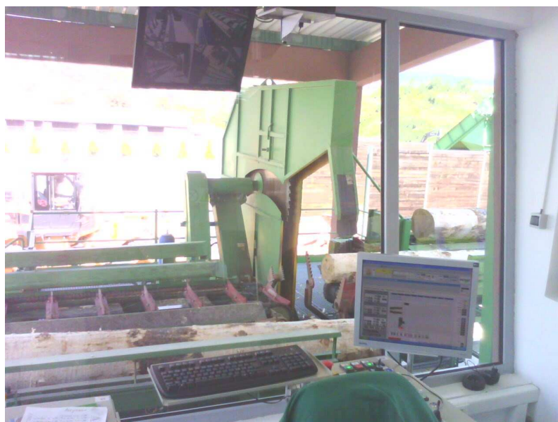
Sl. 28. Pila za kraćenje ZPK 2100 i njeno praćenje na računaru
