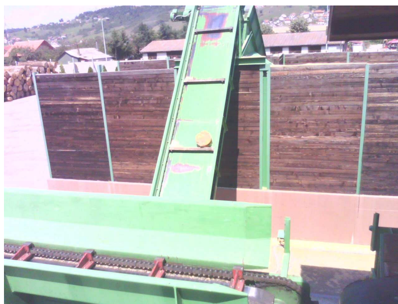
Sl. 29. Transport otpada sa pile za čeljenje do boksa
