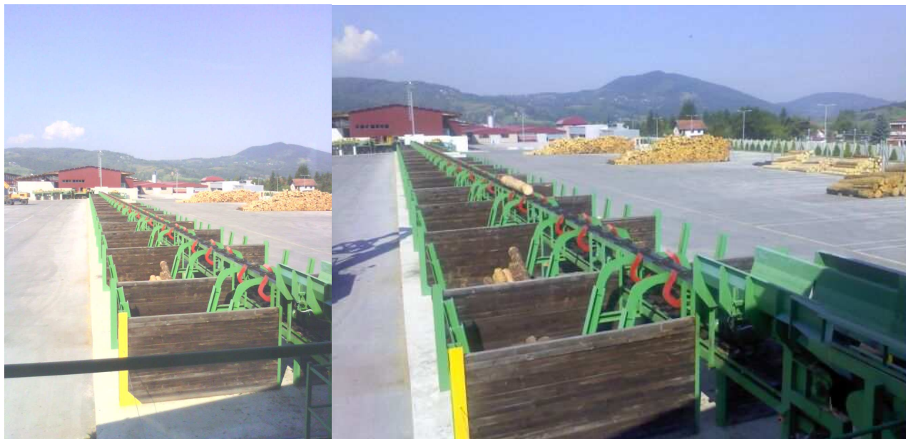
Sl.31. Sortirni transporter sa sortirnim boksovima
