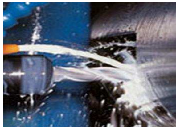
Slika 12. Obrada teškoobradivih čelika bez i sa sredstvom za hlađenje i podmazivanje
