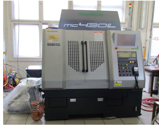
Slika 16. Elektroda za izradu alata i mikroprecizna glodalica
