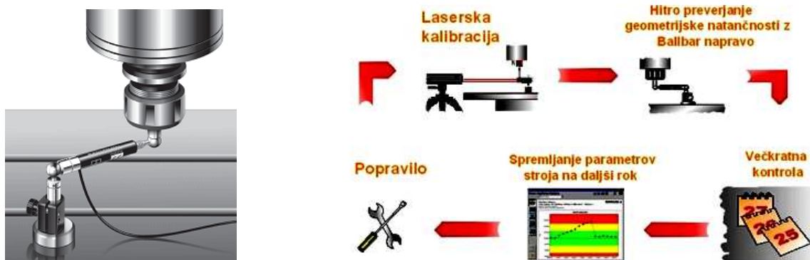
Slika 9. Procedura istraživanja i provjere tačnosti alatne mašine
