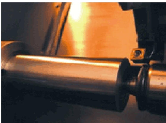
Slika 12. Obrada teškoobradivih čelika bez i sa sredstvom za hlađenje i podmazivanje
