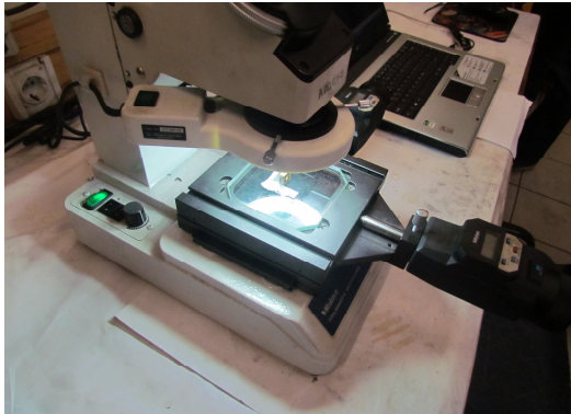
Slika 13. Dvodimezionalno i trodimenzionalno praćenje habanja alata
