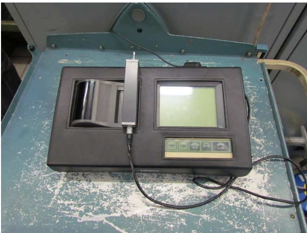
Slika 16. Uređaj za mjerenje hrapavosti MITOTOYO SURFTEST SJ 301
