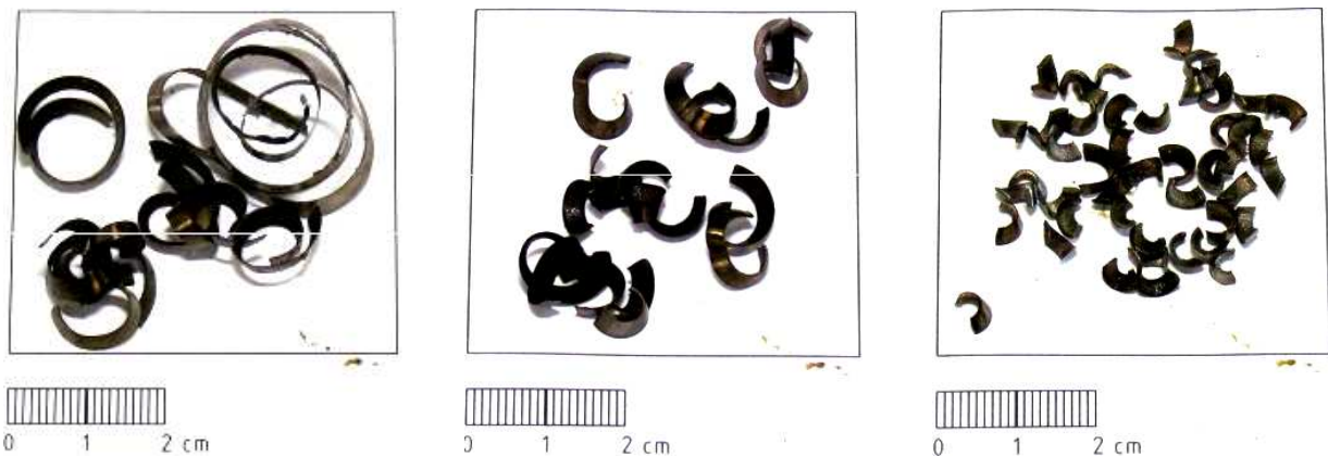
Slika 25. Zavisnost oblika strugotine od promjene koraka i dubine pri obradi sa oblivanjem
