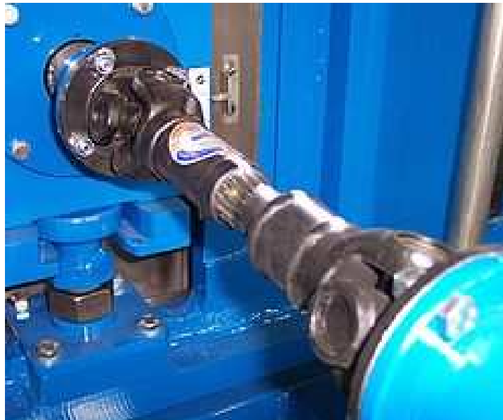
Slika 4. Vratilo izrađeno od čelika Ck45
