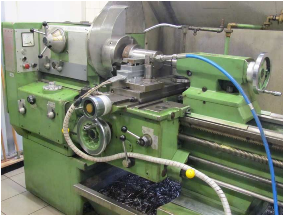
Slika 17. Postupak mjerenja sile rezanja pomoću dinamometra
