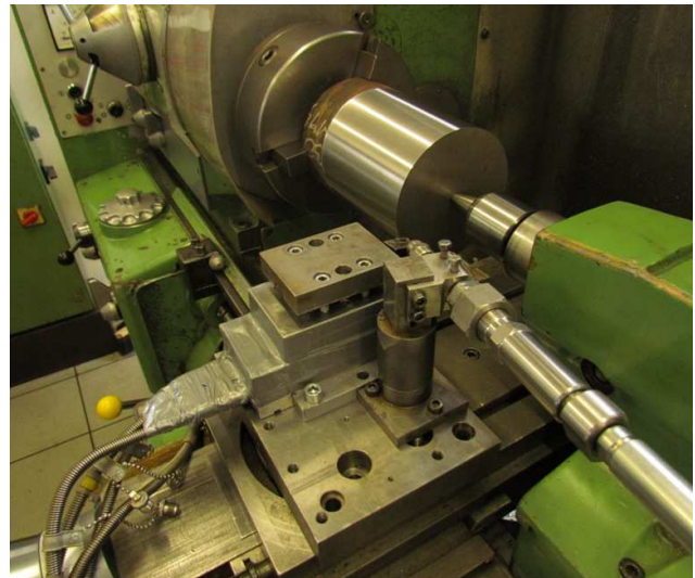
Slika 14. Aparatura za mjerenje sila rezanja "KISTLER"
