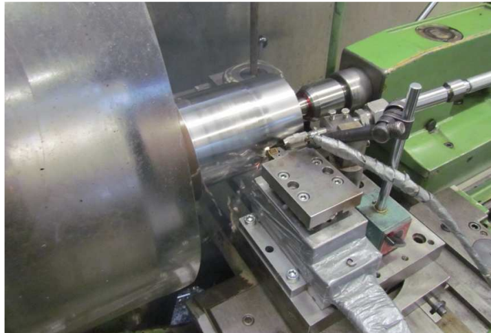
Slika 34. Nastanak nepovoljne strugotine pri obradi sa MQL
