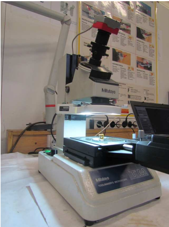
Slika 28. Postupak mjerenja habanja alata i hrapavosti površine
