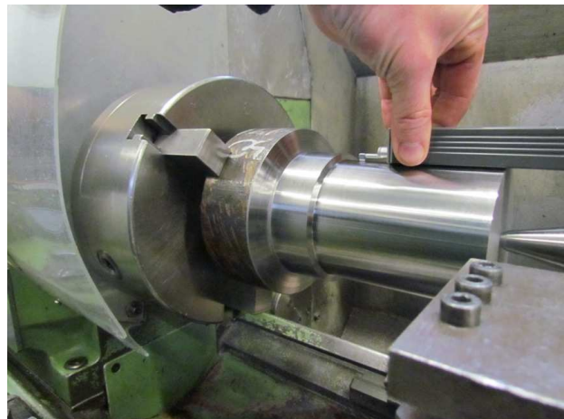
Slika 16. Uređaj za mjerenje hrapavosti MITOTOYO SURFTEST SJ 301
