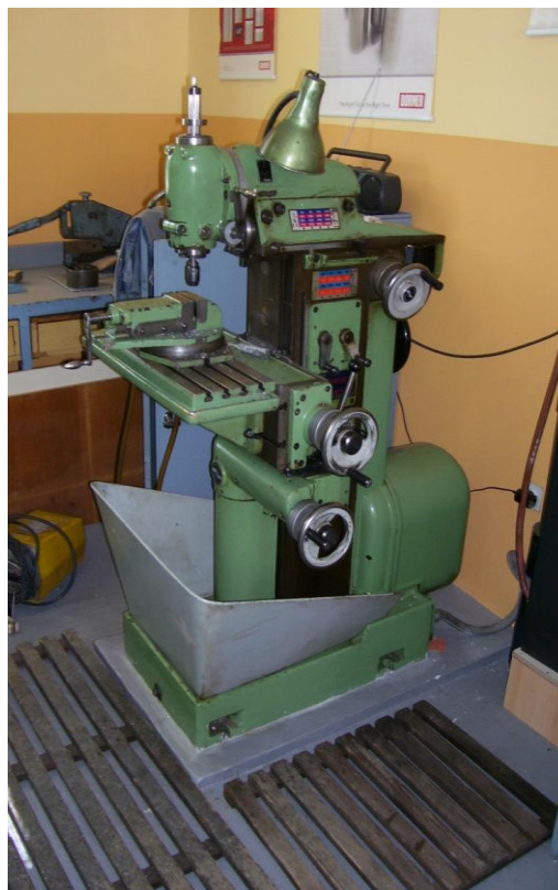
Slika 22. Univerzalna alatna glodalica 'PRVOMAJSKA RAŠA'
