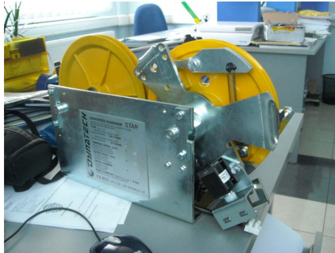
Slika 4. Graničnik maksimalne brzine lifta
